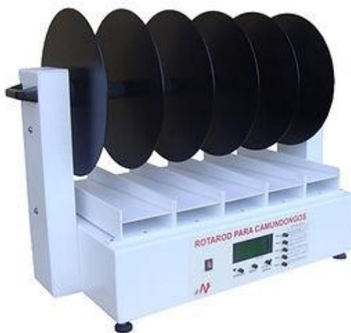
**Figura 2.** Aparelho RotaRod digital utilizado na mensuração da coordenação motora. Disponível em: <https://www.avsprojetos.com.br/product-page/rotarod>. Acesso: 17/05/2023 às 12h52.
