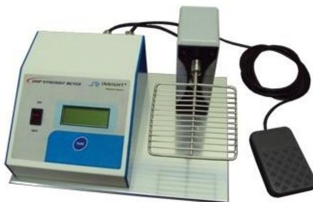
**Figura 3.** Aparelho *Grip Strength Meter* utilizado na mensuração da força muscular. Disponível em: <https://www.insightltda.com.br/produto/eff-305-grip-strenght-meter-ratos-e-camundongos/>. Acesso: 17/05/2023 às 13h08.
