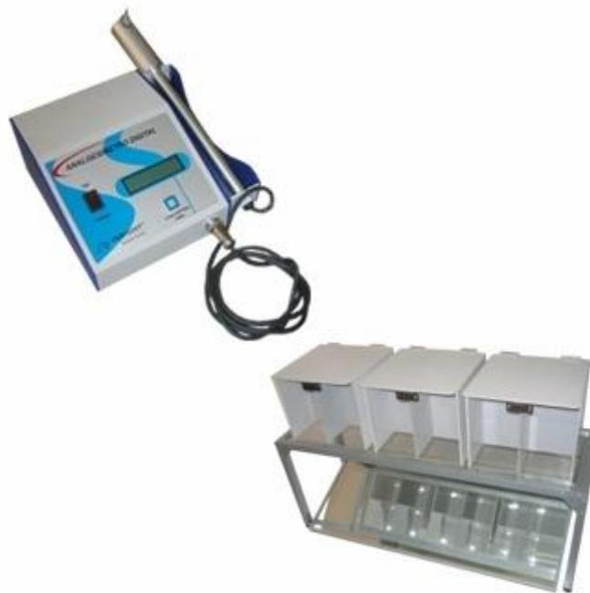
**Figura 1.** Aparelho analgesímetro digital utilizado na mensuração do limiar mecânico de retirada da pata. Disponível em: <https://www.insightltda.com.br/produto/eff-302-analgesimetro-digital-von-frey-acessorios/>. Acesso: 17/05/2023 às 12h52.
