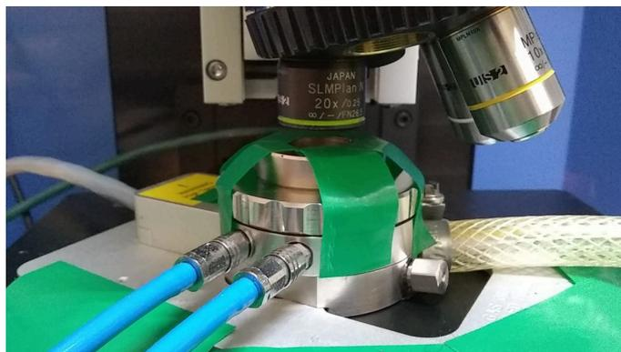
Figura 5.1: Montagem experimental realizado para medidas de Raman com campo magnético.
