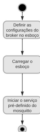
Figura 24 – Fluxo MQTT+TLS
