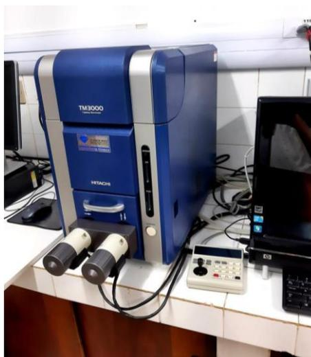
Figura 3.10 – Microscópio Eletrônico de Varredura, HITACHI TM3000.
