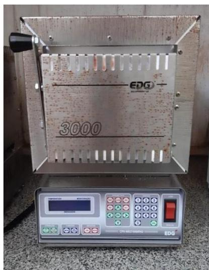
Figura 3.5 – Forno EDG-3000 utilizado para as calcinações, pertencente ao LFM/DFI.
