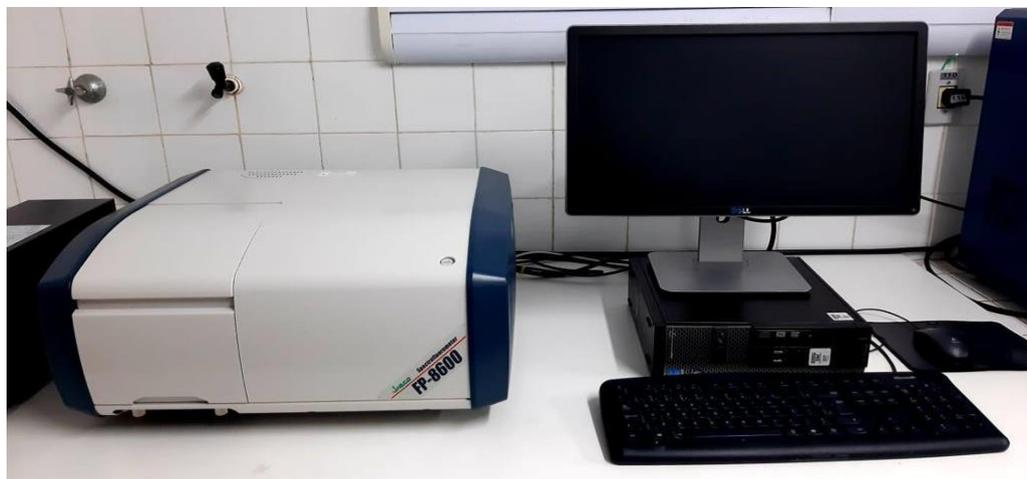
Figura 3.13 – Espectrofluorímetro modelo FP-8600 utilizado para realização das medidas de fotoluminescência.
