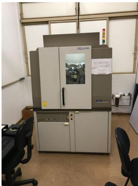
Figura 3.9 – Difratorômetro Rigaku pertencente ao IFUSP.
