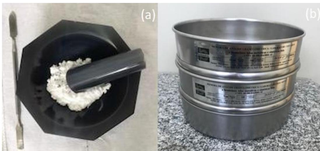
Figura 3.6 – a) Material após a calcinação; b) Peneiras utilizadas para o selecionamento dos grãos dos compostos.
