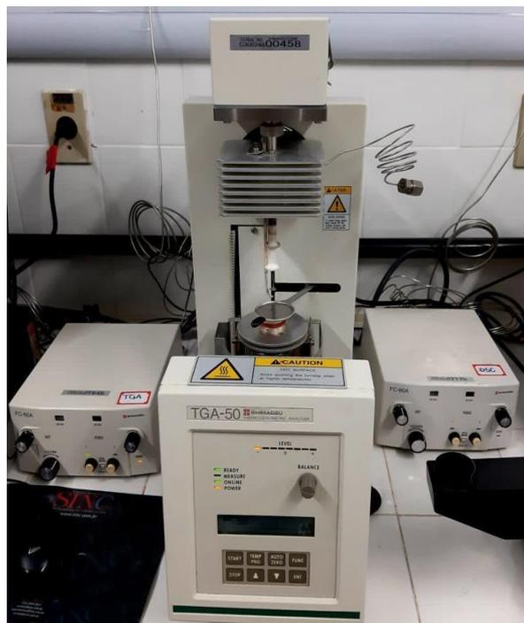
Figura 3.12– Analisador Termogravimétrico TGA-50 – Shimadzu.
