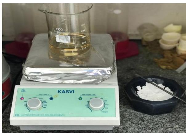
Figura 3.2 – No almofariz, pó obtido após a homogeneização manual do carbonato de cálcio com dopantes; no béquer, ácido sulfúrico posto sobre o agitador magnético.
