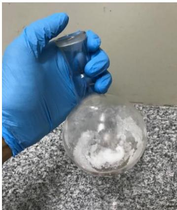
Figura 3.4 – Cristais formados na parede do balão volumétrico.
