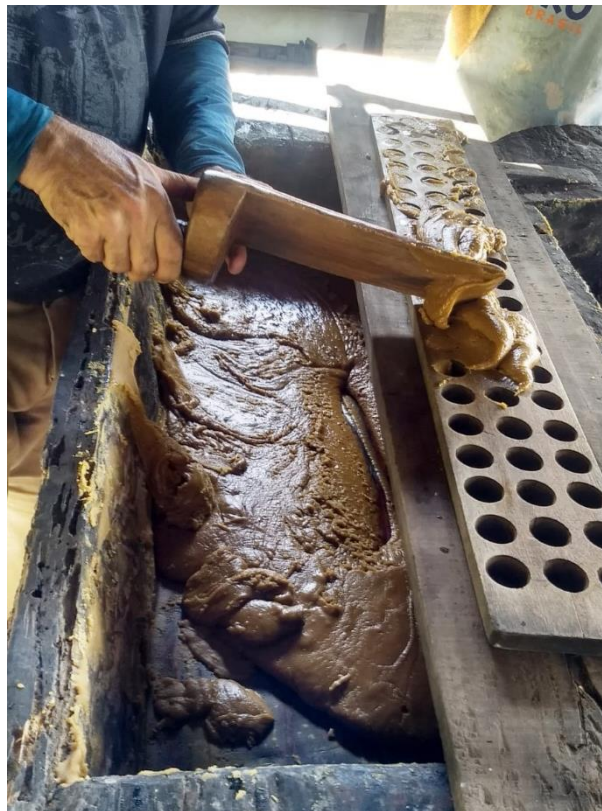
Figura 3: Moldagem de rapadura em molde redondo de 20 gramas no engenho do Louro em Antônio Gonçalves Bahia.
