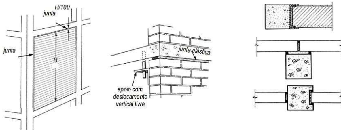
Figura 9 – Juntas elásticas de dilatação
