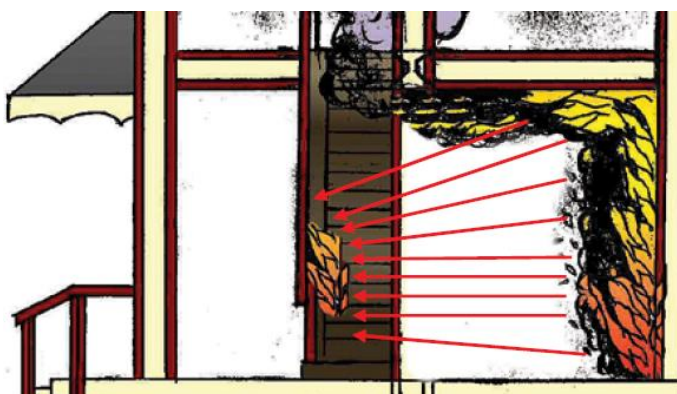
Figura 8: Transferência de calor por irradiação para um ponto distante do foco
