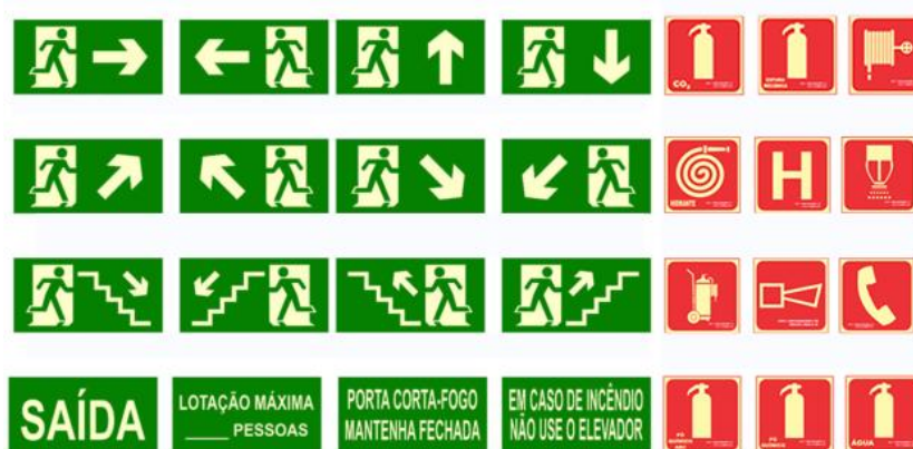
Figura 35: Símbologia das sinalizações de emergência.
