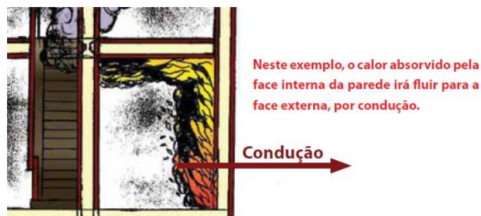
Figura 4: Transferência de calor por condução através da parede
