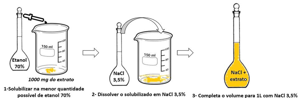
Figura 9 - Esquema de Preparação da solução com o extrato de *Anacardium Occidentale*.
