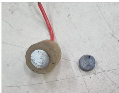
Figura 10 - Amostras utilizadas para os ensaios eletroquímicos e ensaios gravimétricos.
