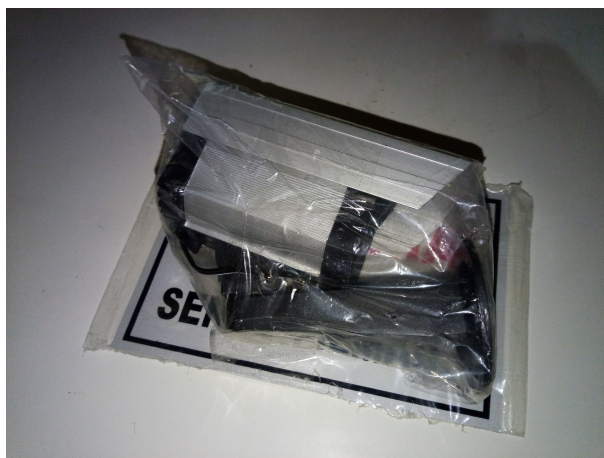
Figura 62 – Carcaça de câmera falsa utilizada na montagem do dispositivo de captura das imagens
