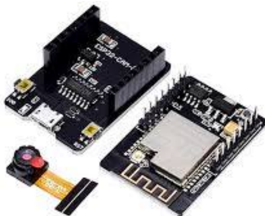
Figura 59 – Esp32Cam com módulo para carregamento de firmware e câmera
