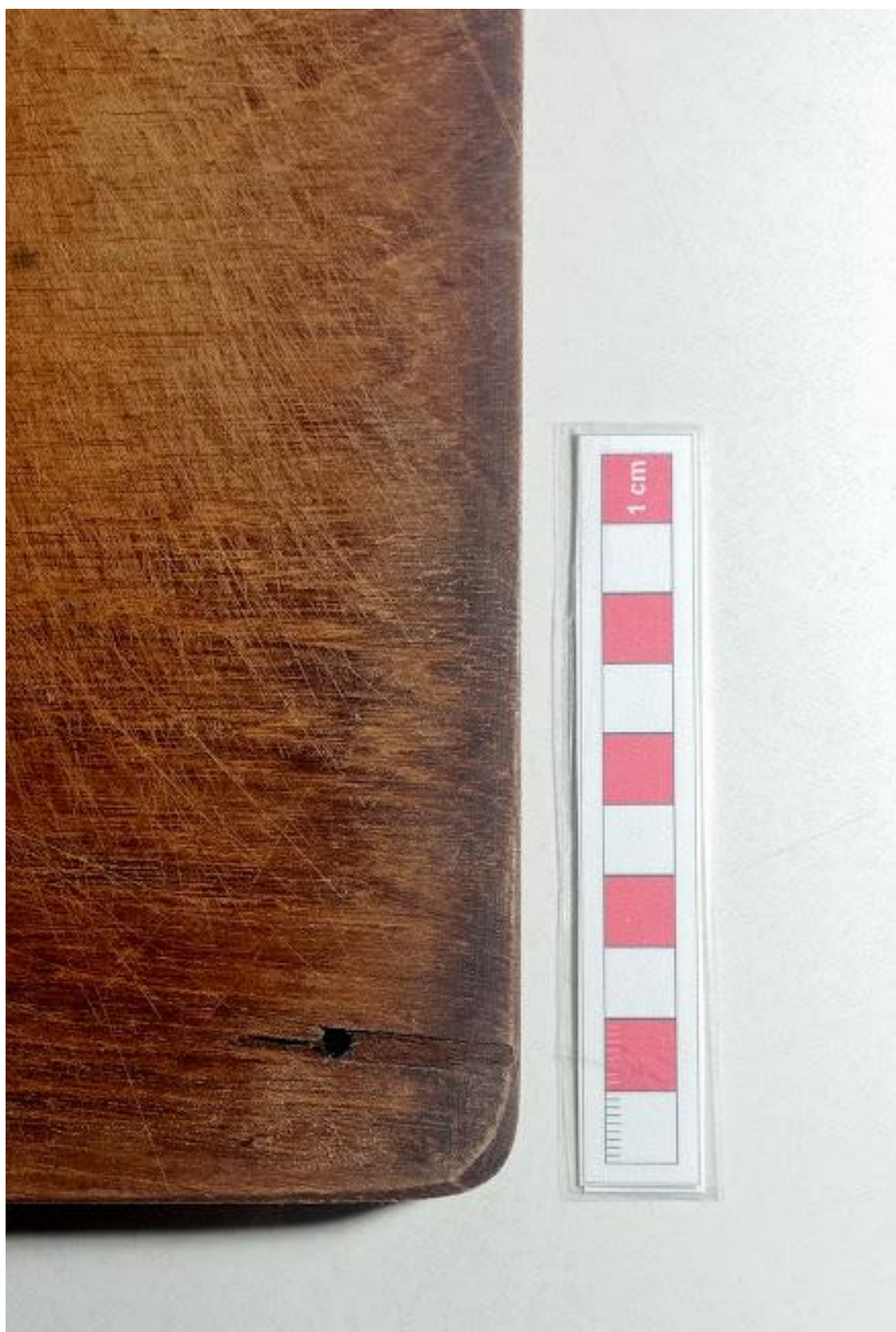
Fotografia 5 – Lasca retirada no canto inferior da face traseira
