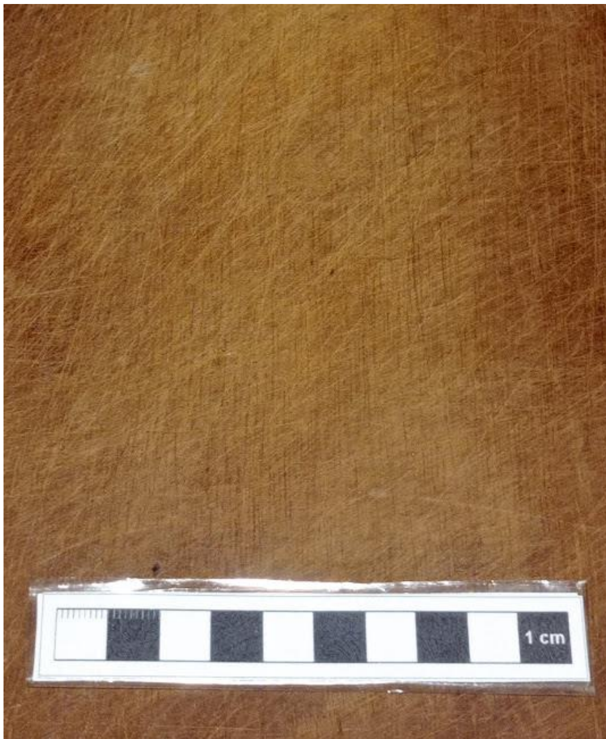
Fotografia 4 – Cortes, listras, manchas e pontos escuros
