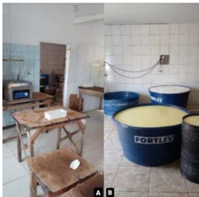
Figura 10- Queijarias impróprias no município de Poeto da Folha-SE. (A) Mesas de madeira inadequadas para a fabricação de produtos lácteos. (B) Tanques de polietileno inapropriados para armazenar soros para queijo e manteiga
