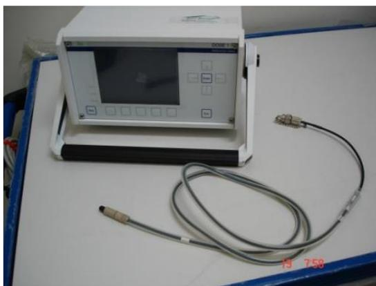
Figura 19- Conjunto dosimétrico, eletrômetro Dose1 e câmara de ionização CC13.
