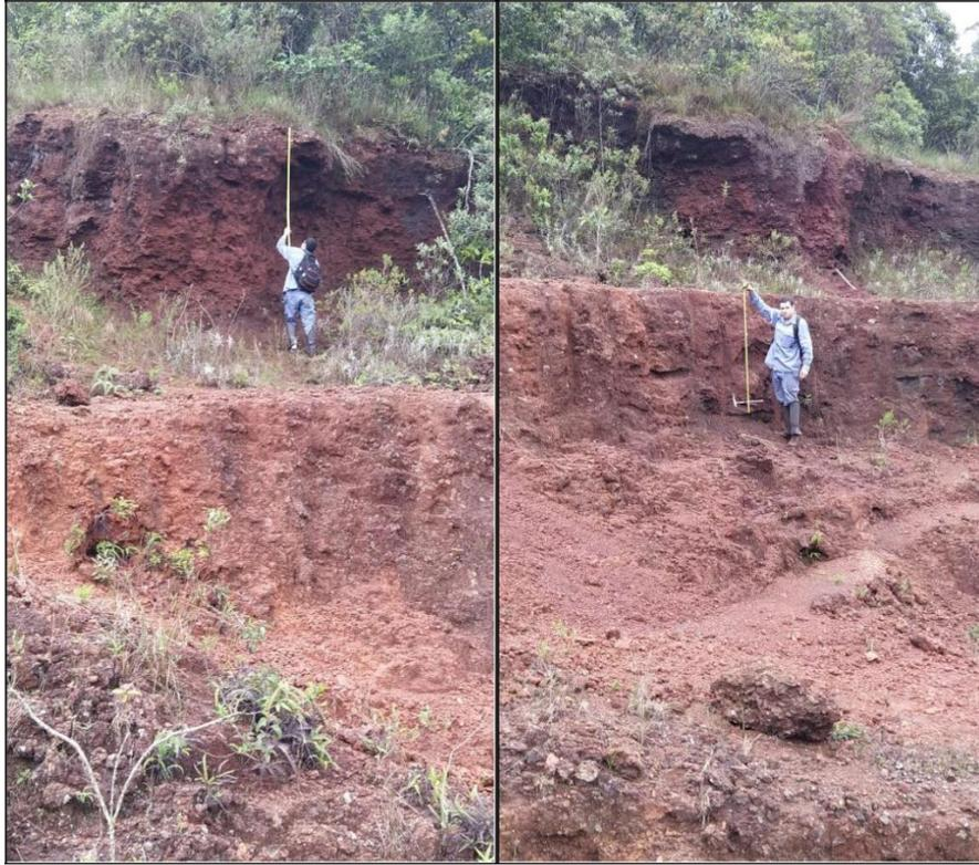
**Figura 20 B** - Perfil no talude mostrando a espessura de cerca de 5,50m de canga + laterita.
