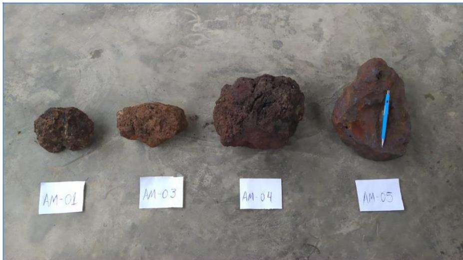
Figura 7 - Amostras das cangas analisadas para densidade (Fonte: autor).
