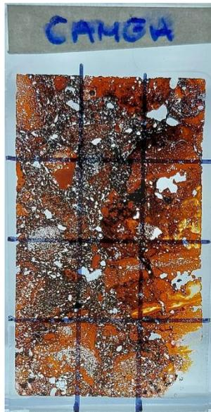
**Figura 33** - Lâmina delgada da canga (Fonte: autor).
