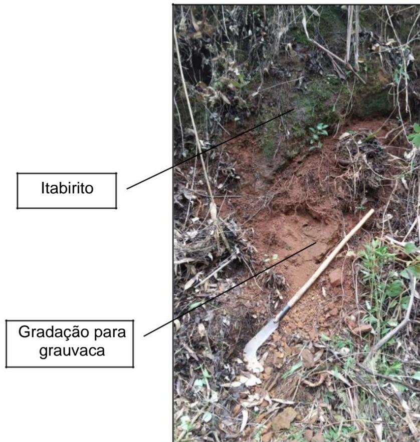
**Figura 25 C** - Contato gradacional entre o itabirito e a metagrauvaca no ponto 134, atitude Sb: 125/35 (Fonte: autor).
