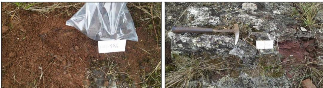
**Figura 5** - Esquerda: amostra de canga com laterita (AM-186). Direita: amostra de itabirito cangeificado (AM-174) (Fonte: autor).
