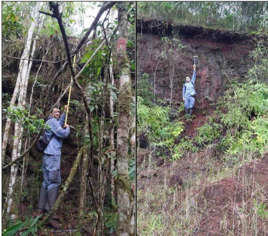
**Figura 20 C** - Esquerda: ponto 166: mínimo de 4,70m de canga + laterita. Direita: talude na cava: mínimo de 6,00m canga + laterita (Fonte: autor).
