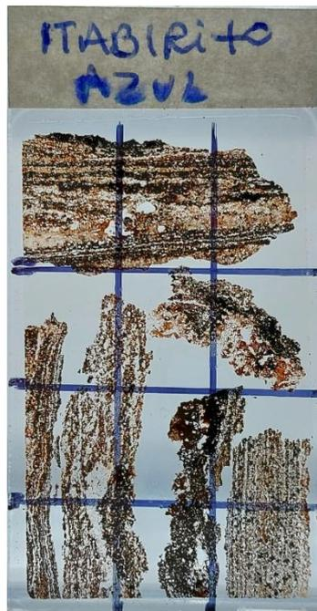
**Figura 38** - Lâmina delgada do itabirito azul (Fonte: autor).
