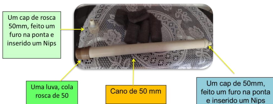
Figura 3. Filtro construído com cano de pvc de 50mm. Fonte: Autora 2022.
