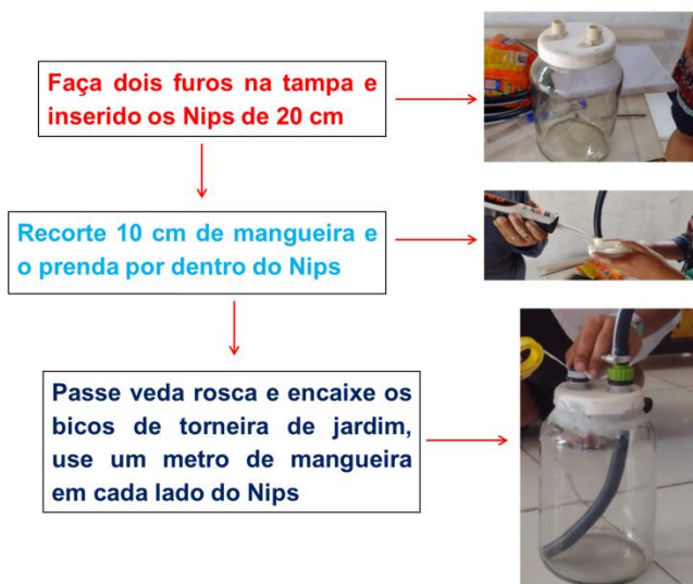
Fluxograma 3. Filtro construído com um frasco de vidro de 3 litros. Fonte: Autora 2022.
