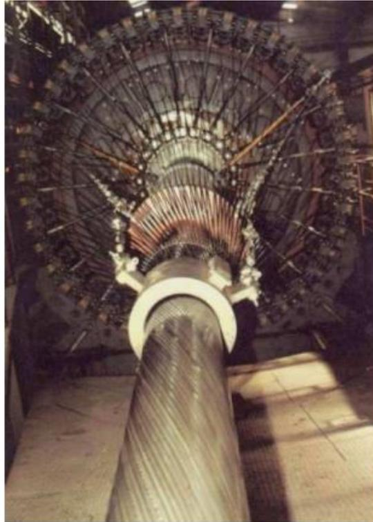
**Figura 2:** Etapa de enrolamento dos arames da armadura de tração na fabricação do umbilical [7].
