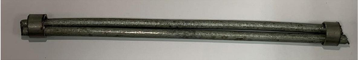
**Figura 15:** Dispositivo de fricção fadiga desenvolvido para acoplamento dos corpos de prova no ensaio de fadiga. Fonte: Fonte: Própria, 2023.
