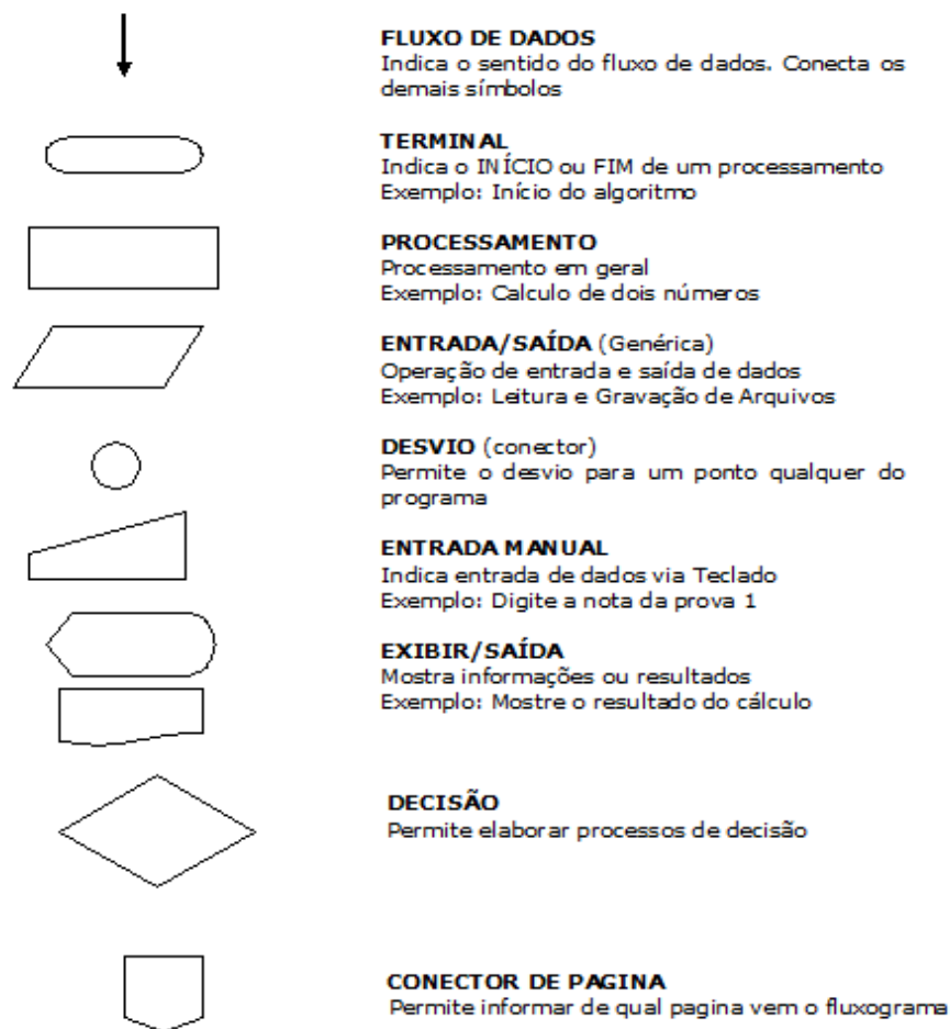
Figura 3 - Representação esquemática das formas geométricas que constituem um fluxograma
