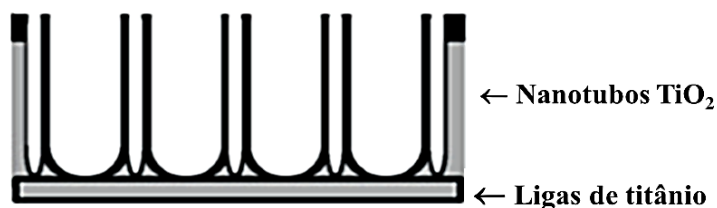
Figura 3.18. Esquematização da formação de nanotubos em ligas de titânio (BRAMMER et al. 2013).
