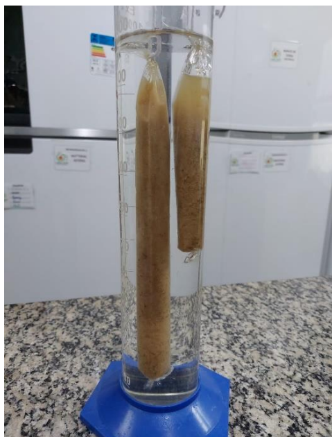
Figura 5 - Tubo de diálise de celulose com o subproduto de umbu-cajá liofilizado pré-digerido.
