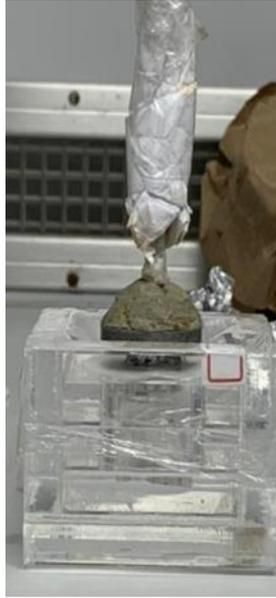
Figura 3-3 – Fonte emissora de partículas  $\beta$  colocada no suporte de acrílico para irradiação das amostras.
