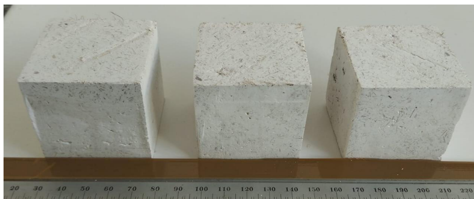
Figura 6. Gesso puro com 5% de fibra com acabamento superficial.
