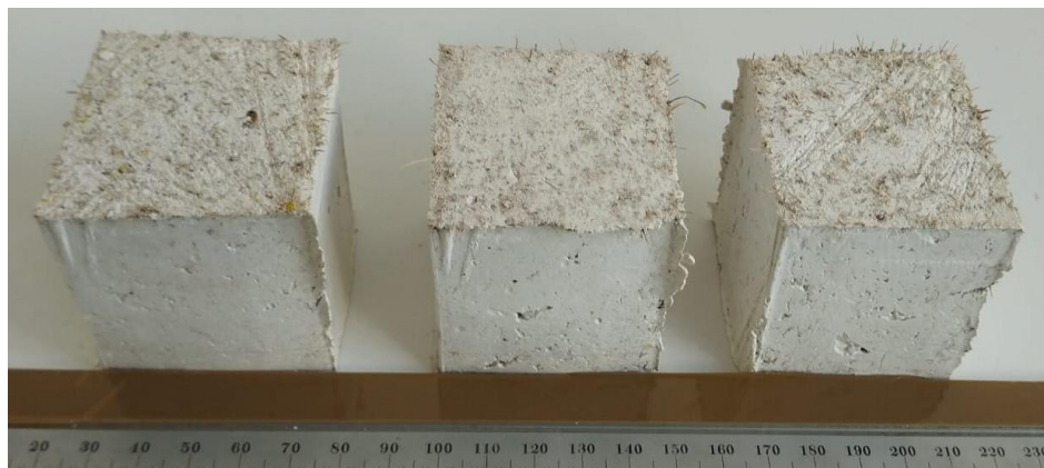
Figura 5. Gesso puro com 5% de fibra sem acabamento superficial.
