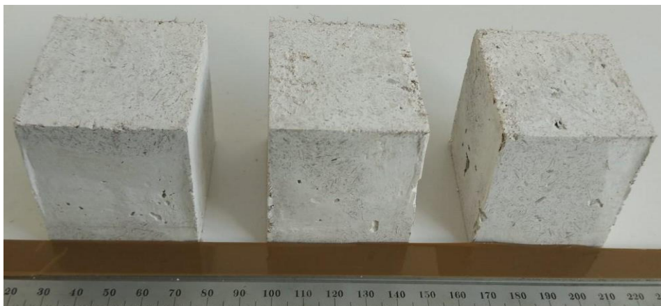
Figura 14. Gesso aditivado com 10% de fibra com acabamento superficial.
