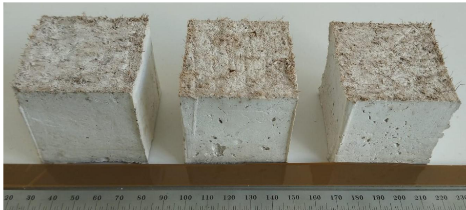
Figura 13. Gesso aditivado com 10% de fibra sem acabamento superficial.
