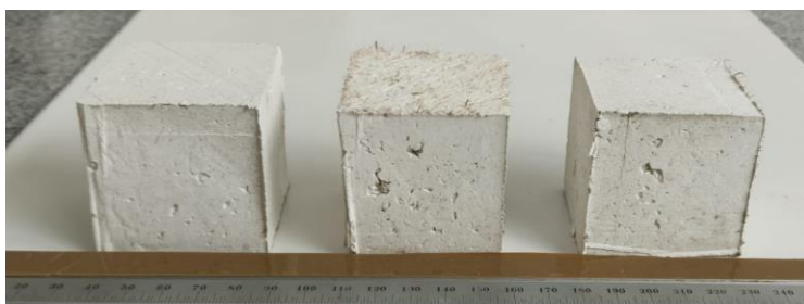
Figura 11. Vista lateral dos corpos de prova do compósito matriz gesso puro-5% fibra.
