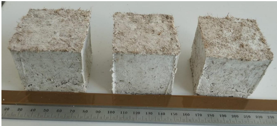
Figura 7. Gesso puro com 10% de fibra sem acabamento superficial.
