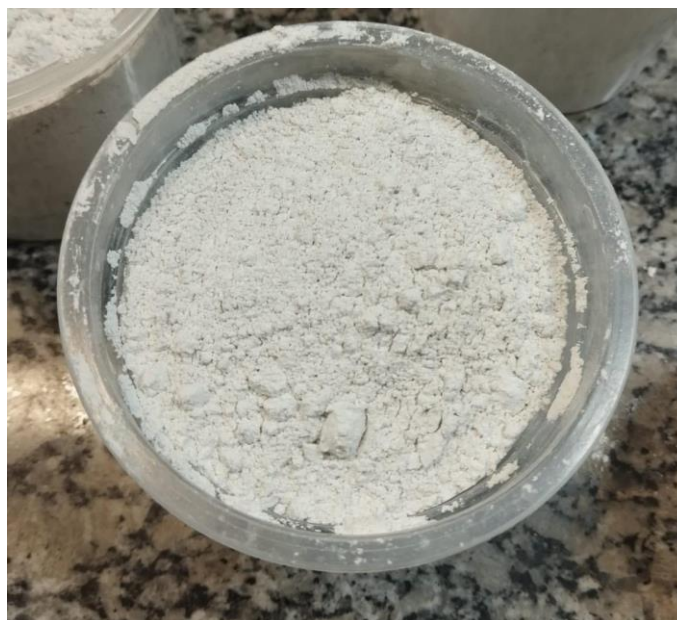
Figura 3. Gesso comercial puro empregado como matriz dos compósitos.
