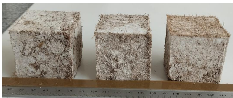
Figura 16. Vista lateral dos corpos de prova do compósito matriz gesso aditivado-20% fibra.
