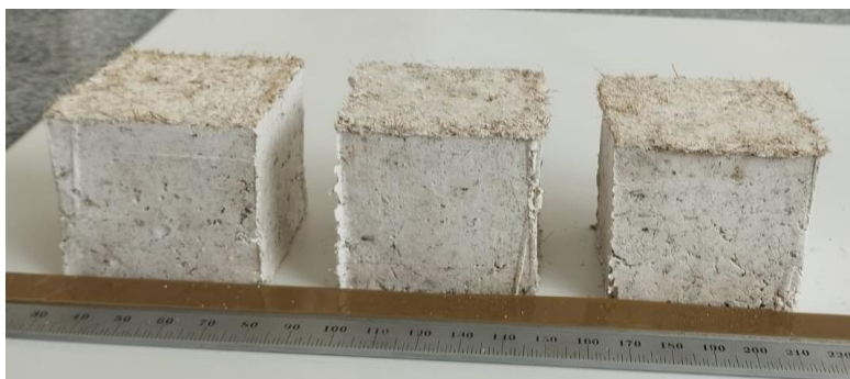
Figura 13. Vista lateral dos corpos de prova do compósito matriz gesso puro-10% fibra.
