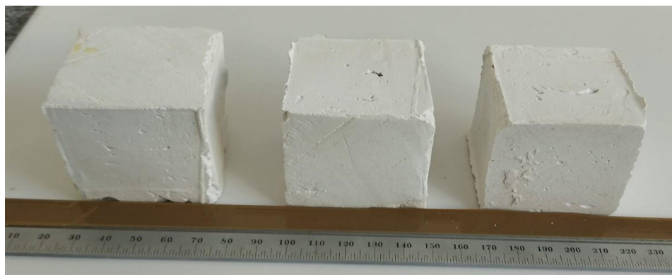
Figura 3. Gesso aditivado sem acabamento superficial.
