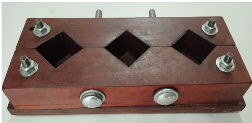
Figura 7. Molde 2 empregado na produção dos corpos de prova de compressão.
