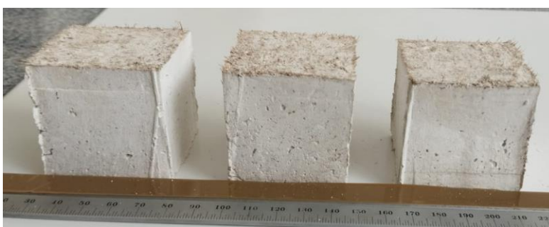
Figura 14. Vista lateral dos corpos de prova do compósito matriz gesso aditivado-10% fibra.
