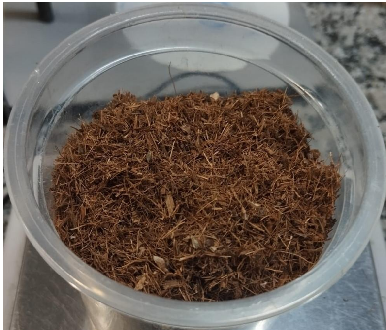
Figura 4. Fibra de coco verde empregada na fabricação dos compósitos.
