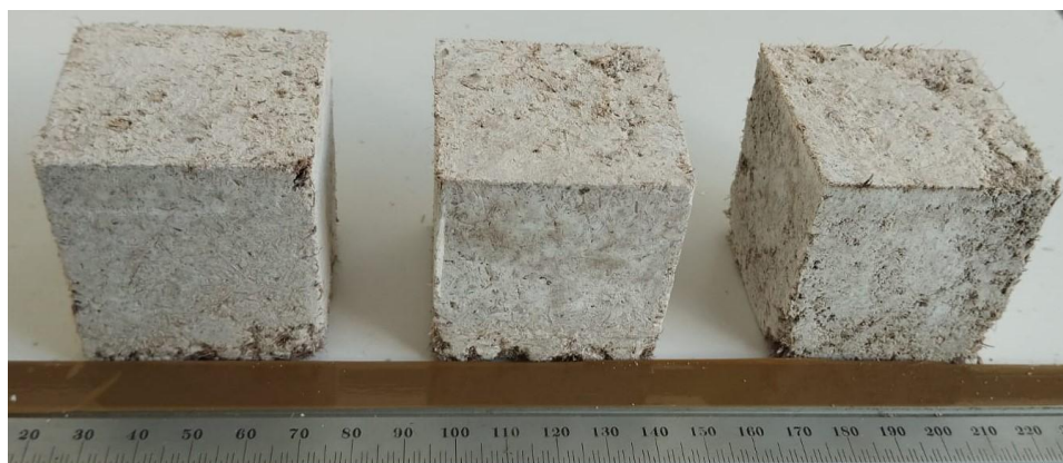
Figura 10. Gesso puro com 20% de fibra com acabamento superficial.
