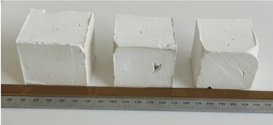
Figura 1. Gesso puro sem acabamento superficial.
