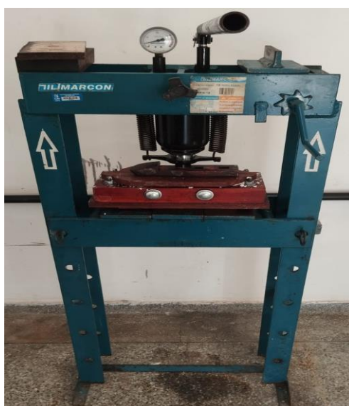
Figura 8. Compactação dos corpos de prova utilizando prensa hidráulica.
