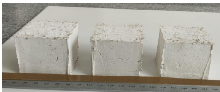
Figura 12. Vista lateral dos corpos de prova do compósito matriz gesso aditivado-5% fibra.
