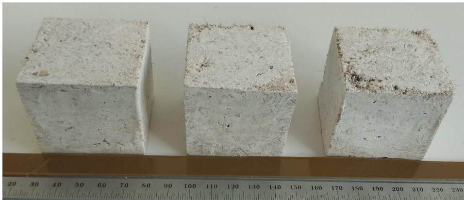
Figura 8. Gesso puro com 10% de fibra com acabamento superficial.
