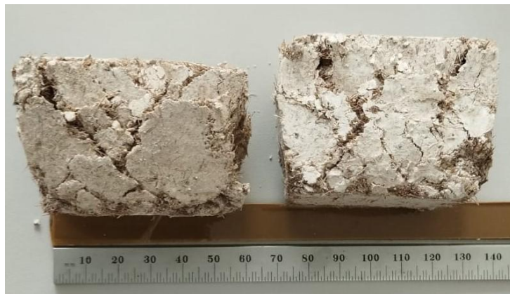
Figura 4. Vista lateral dos corpos de prova após ensaio de compressão. Compósitos de gesso aditivado – 20% fibra (esquerda) e gesso puro – 20% fibra (direita).
