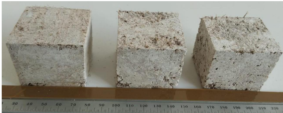
Figura 16. Gesso aditivado com 20% de fibra com acabamento superficial.
