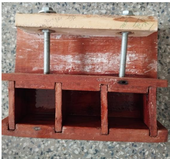
Figura 6. Molde 1 empregado na produção dos corpos de prova de compressão.
