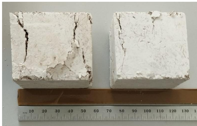
Figura 2. Vista lateral dos corpos de prova após ensaio de compressão. Compósitos de gesso aditivado – 5% de fibra (esquerda) e de gesso puro – 5% fibra (direita).
