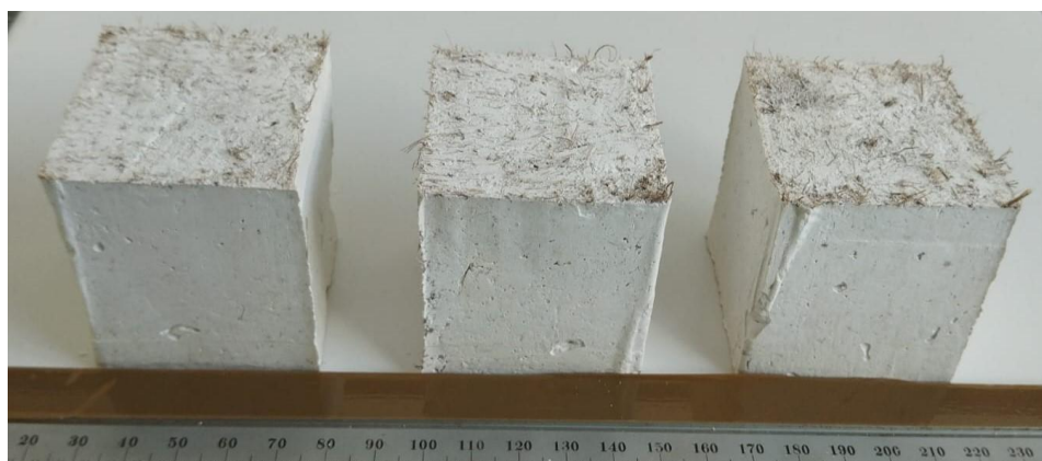
Figura 11. Gesso aditivado com 5% de fibra sem acabamento superficial.
