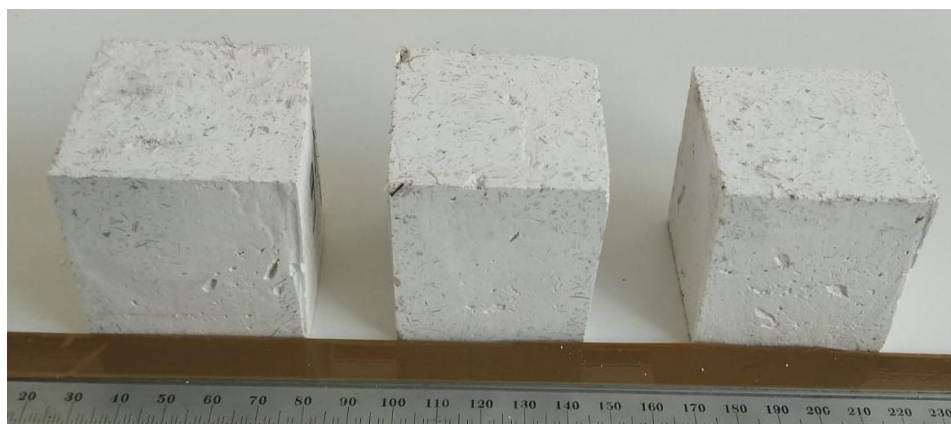
Figura 12. Gesso aditivado com 5% de fibra com acabamento superficial.
