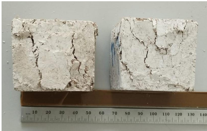
Figura 3. Vista lateral dos corpos de prova após ensaio de compressão. Compósitos de gesso aditivado – 10% fibra (esquerda) e gesso puro – 10% de fibra (direita).
