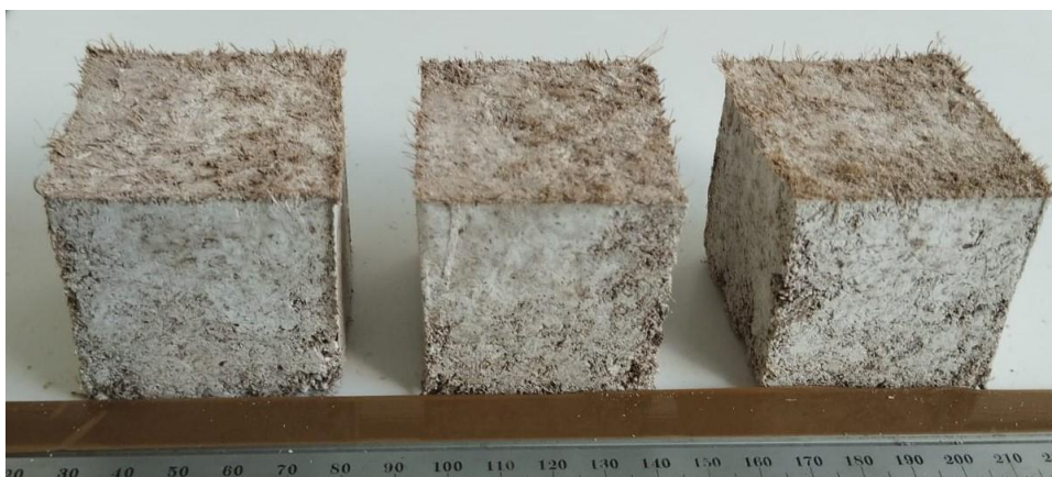
Figura 9. Gesso puro com 20% de fibra sem acabamento superficial.
