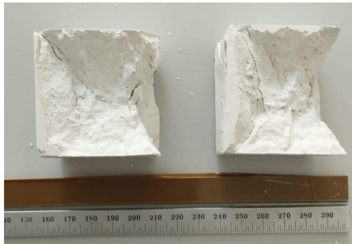
Figura 1. Vista lateral dos corpos de prova após ensaio de compressão. Gesso aditivado (esquerda) e gesso puro (direita).
