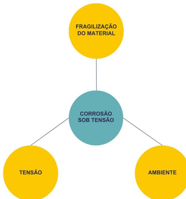
Figura 1 - Os três principais elementos para ocorrer a corrosão sob tensão.
