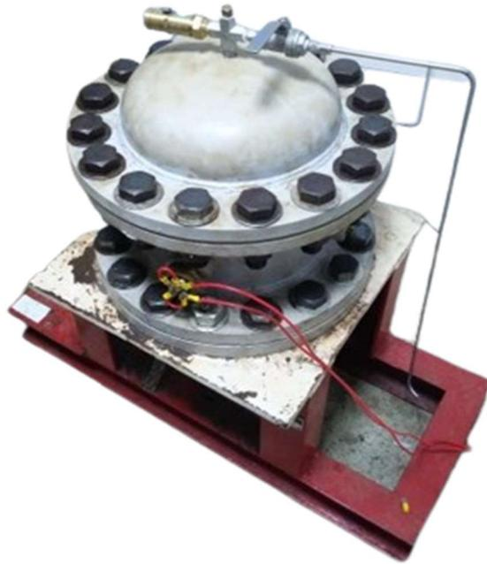
Figura 4 - Autoclave de ensaio de corrosão sob tensão.
