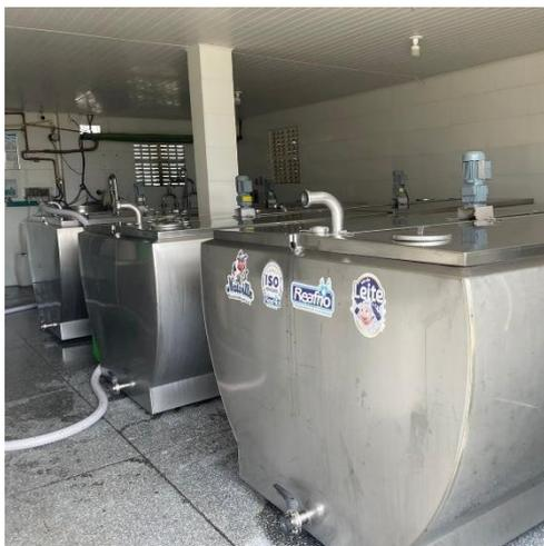
Figura 4: Tanques refrigeração de leite com capacidade de 5.000 litros cada fazenda Lagoa Nova.
