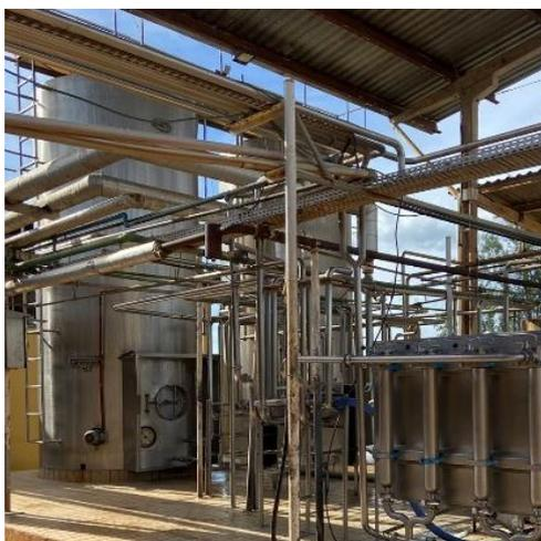
Figura 7: Tanques com capacidade de 20.000 litros cada. Fonte: Arquivo pessoal.
