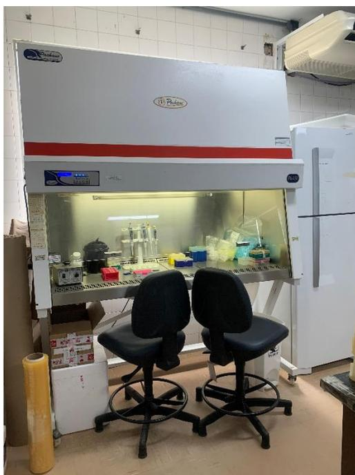
**Figura 10:** Cabine de Segurança Biológica utilizada para realizar procedimentos no LPC. Fonte: Arquivo Pessoal, 2023.
