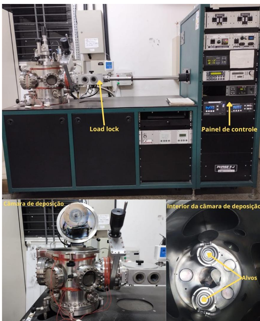
Figura 6. Equipamento de deposição magnetron sputtering utilizado nas deposições dos filmes finos.
