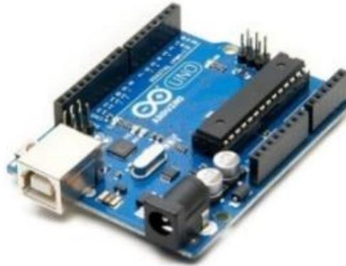
**Figura 4 - Placa de Arduino para Programação**
