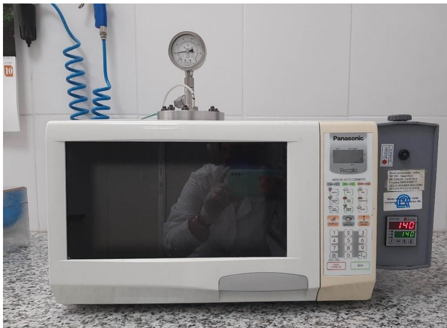
Figura 3. 2: Forno micro-ondas adaptado para o método hidrotérmico utilizado para a síntese das amostras, no Laboratório de Preparação e Caracterização de Materiais (LPCM-UFS). Fonte: arquivo pessoal.
