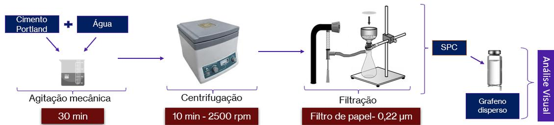
Figura 15. Esquema ilustrando a produção da solução de poros de cimento e o experimento para estabilização da dispersão de GNP na presença de SPC.
