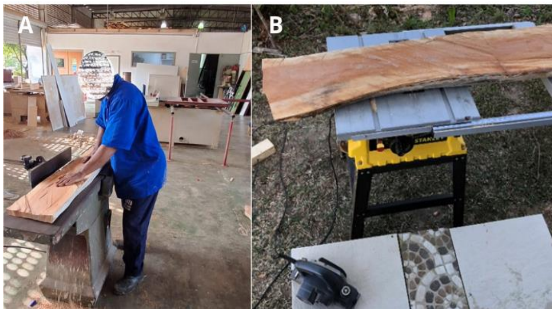
FIGURA 3 – Processo de aplainamento das tábuas. Em que: A) aplainamento executado no LUPM/DCF e B) aplainamento executado no C. P. D. S. Oxogumlade FONTE: AUTOR (2024)
