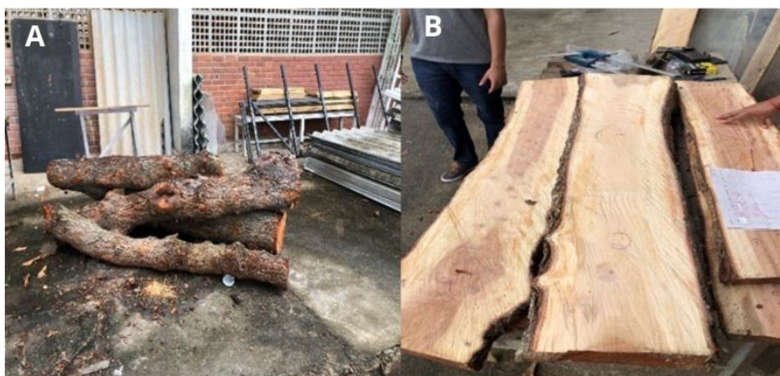
Figura 1 – Material biológico utilizado no experimento. Em que: A) Toras de Azadirachta indica juss e B) Tábuas obtidas após o processamento primário com motosserra FONTE: AUTOR (2024)
