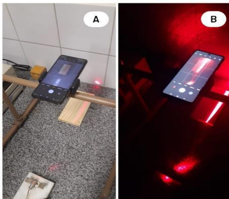
FIGURA 5 – Estrutura sunset laser. Em que: A) estrutura de suporte do sunset laser e B) estrutura em uso com baixa iluminação externa para não interferir na coleta de dados Fonte: ROCHA (2023)
