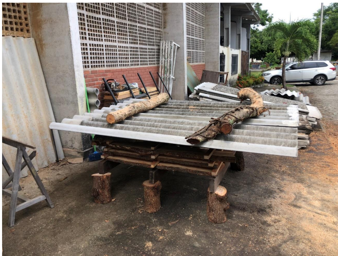
FIGURA 2 – Montagem da pilha de secagem FONTE: AUTOR (2024)
