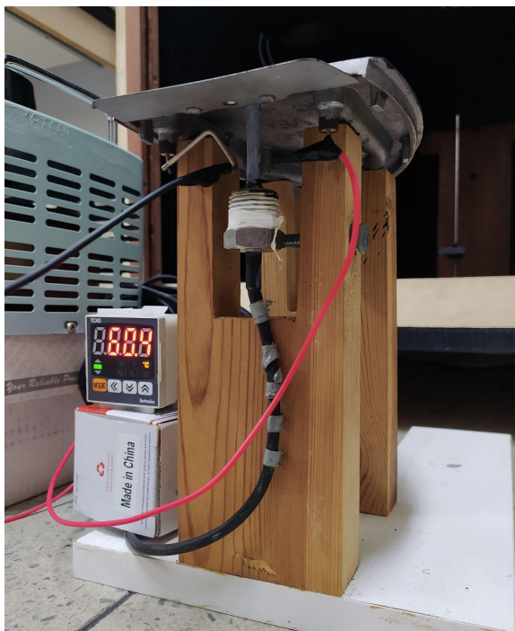
Figura 25: Estrutura de aquecimento.
