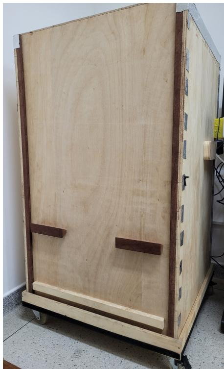
Figura 4.4 – Câmara escura utilizada para os ensaios *DLIT*.
