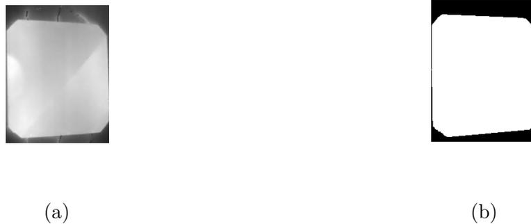
Figura 4.14 – Segmentação da área da célula utilizando método do limiar de Otsu. (a) Imagem em tons de cinza dos dados radiométricos do ensaio, (b) Máscara para segmentação da célula.
