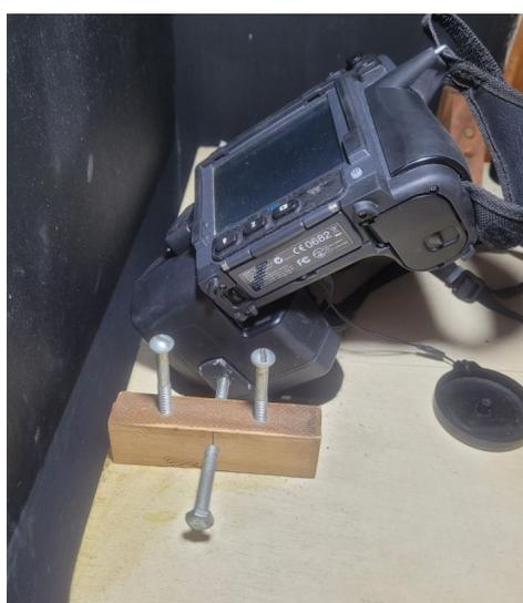
Figura 4.6 – Suporte desenvolvido para fixação da câmera, buscando padronizar os ensaios.
