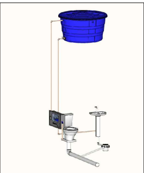
3D DOS PONTOS HIDRÁULICOS
