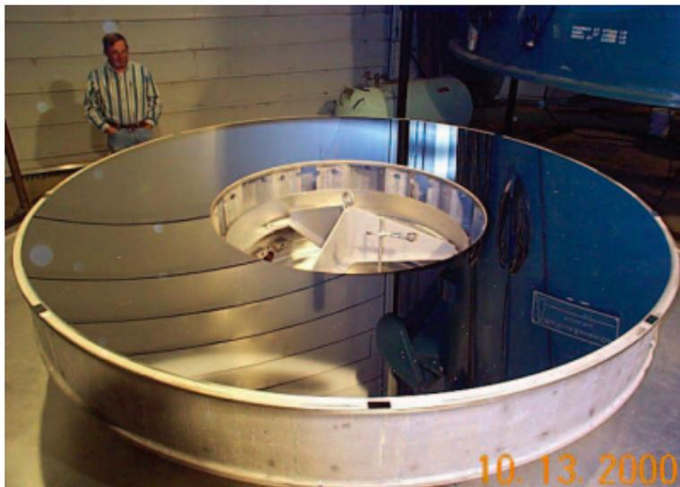
**Figura 3.2:** O espelho primário do *Sloan Foundation Telescope* de 2,5 m fotografado logo após passar pelo processo de realuminização nos laboratórios do Kitt Peak National Observatory, em 13 de outubro de 2000. O orifício central muito grande tem a função de acomodar o amplo campo de visão. Figura reproduzida de Gunn et al. (2006).
