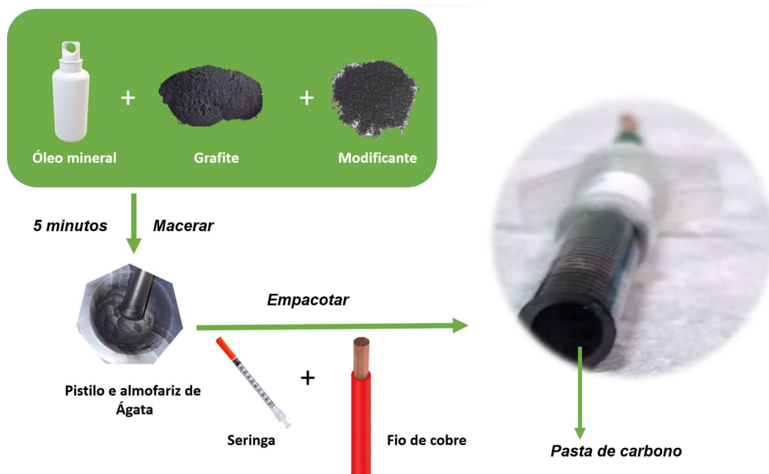
Figura 24 - Esquema ilustrativo do preparo e montagem do eletrodo de pasta de carbono.
