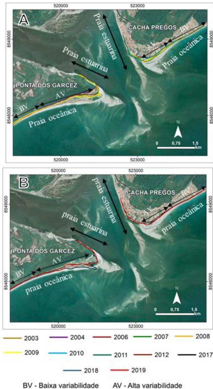
**Figura 6.** Linhas de costa históricas de Cacha Pregos e Ponta dos Garcez: (A) 2003 a 2011, (B) 2011 a 2019. Na figura estão mostradas a subdivisão das partes oceânicas, com baixa e alta variabilidade morfológica, e estuarinas. Fonte da imagem: CNES/AIRBUS, 2019.
