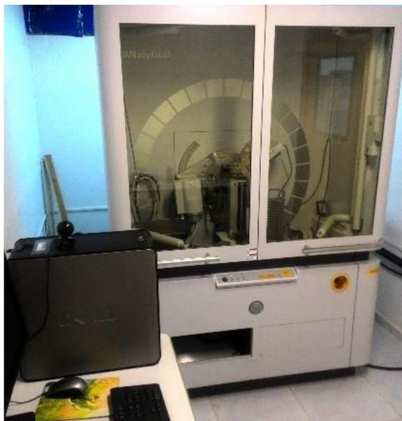
*Figura 10: Difratorômetro EMPYREAN SERIES 2 usado na medição dos padrões de DRX. Retirada da Ref. [82].*
