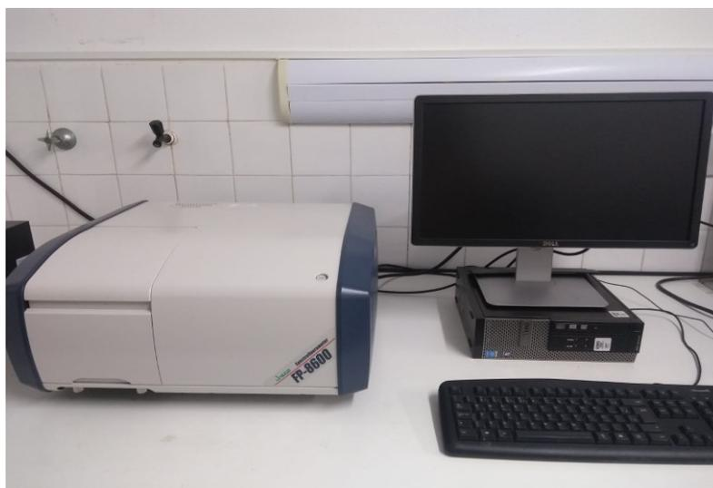
*Figura 11: Espectrofluorímetro modelo FP-8600 usado para realização das medidas de fotoluminescência. E o computador acoplado para visualização e extração dos dados.*
