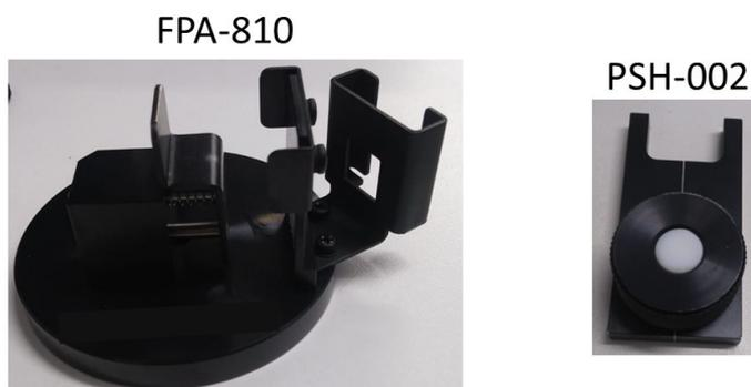
*Figura 12: Suporte de modelo FPA – 810 e modelo de cela PSH – 002 para amostra em pó.*
