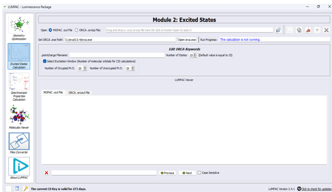
Figura 53. Módulo responsável pelo cálculo da energia dos estados excitados dos ligantes do sistema usando o programa ORCA.
