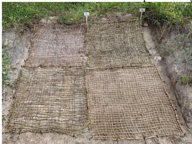
Figura 3. Geotêxtil de taboa tratado com NaOH em processo degradação no talude.
