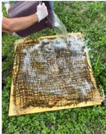
Figura 6. Geotêxtil de taboa tratado com NaOH sendo lavado.
