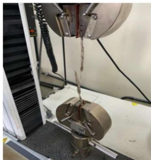
Figura 8. Par de garras em aço da máquina de tração.
