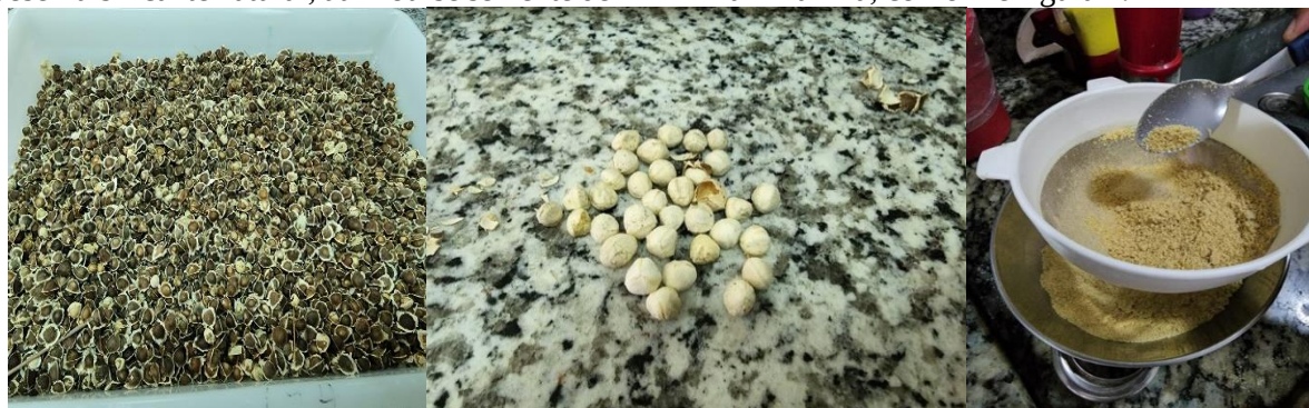
Figura 1. Processo de beneficiamento da semente de moringa para obtenção do coagulante em pó.
