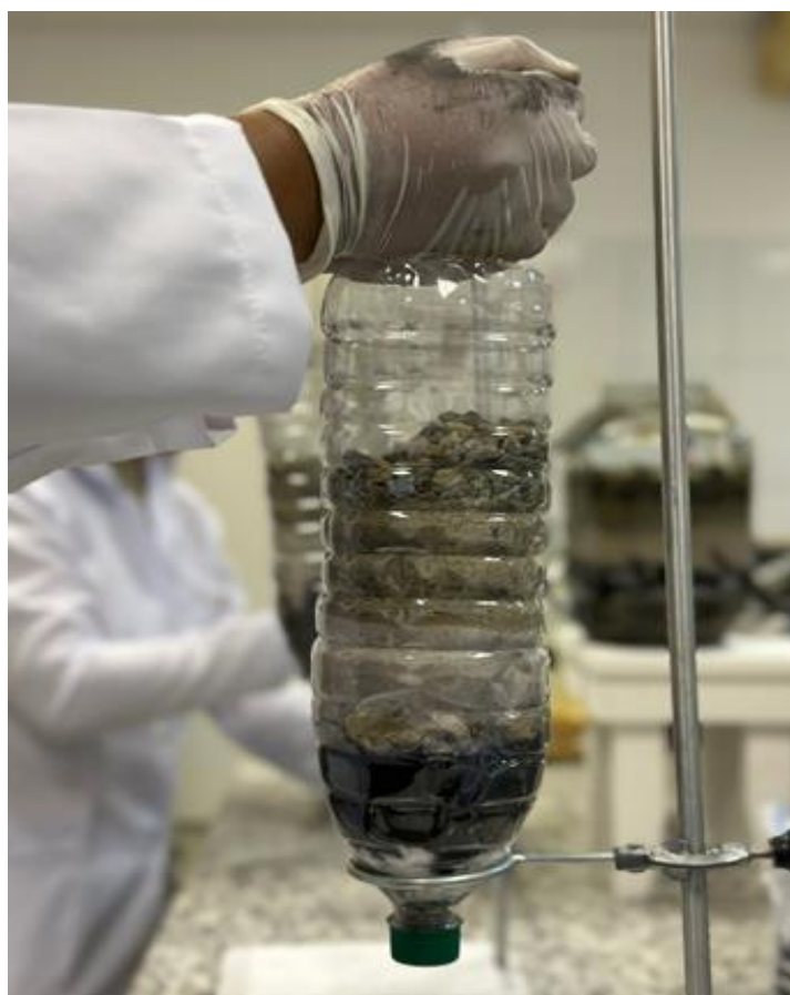
Figura 20 – Filtro para purificação da água com carvão ativado, moringa e algodão.
