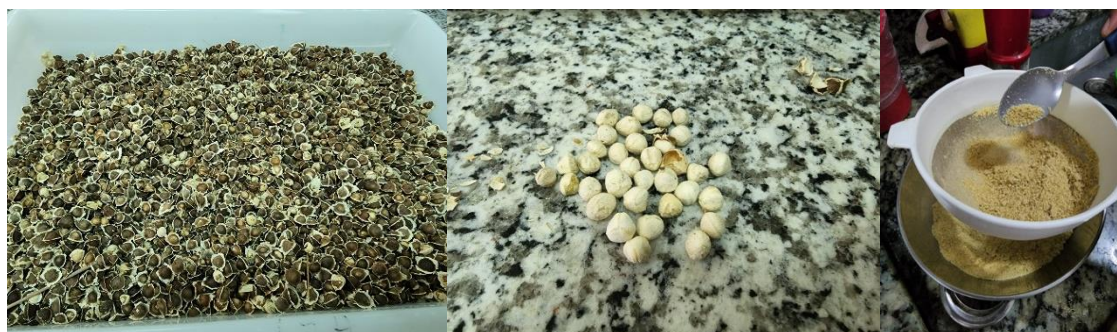
Figura 5. Processo de beneficiamento da semente de moringa para obtenção do coagulante em pó.
