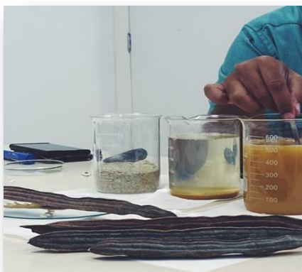
Figura 5. Agitação manual do coagulação na água e redução do índice de turbidez.
