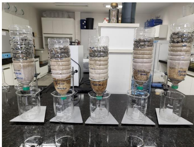
Figura 4. Filtros de Garrafa PET para análises da eficiência da biomassa.
