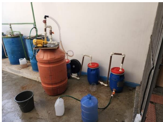
Figura 2. Sistema de FIME domiciliar montado para experimentos.
