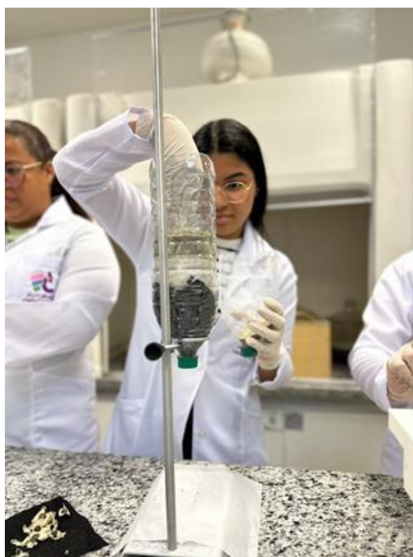
Figura 18. Juliana Souza realizando a montagem do filtro lento com brita nº 2 e pedregulho, areia grossa e fina, carvão ativado e manta, no laboratório de físico-química, no SergipeTec.
