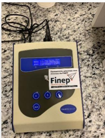
Figura 9. PHmetro utilizado para realizar a leitura do pH verificando assim que solução é básica (pH=11,78).
