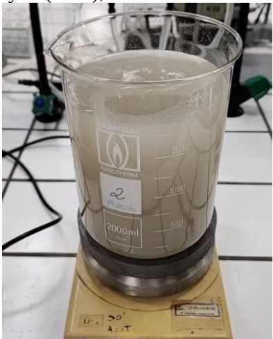
Figura 1. Agitação de água com argila cinza para preparo da água sintética.
