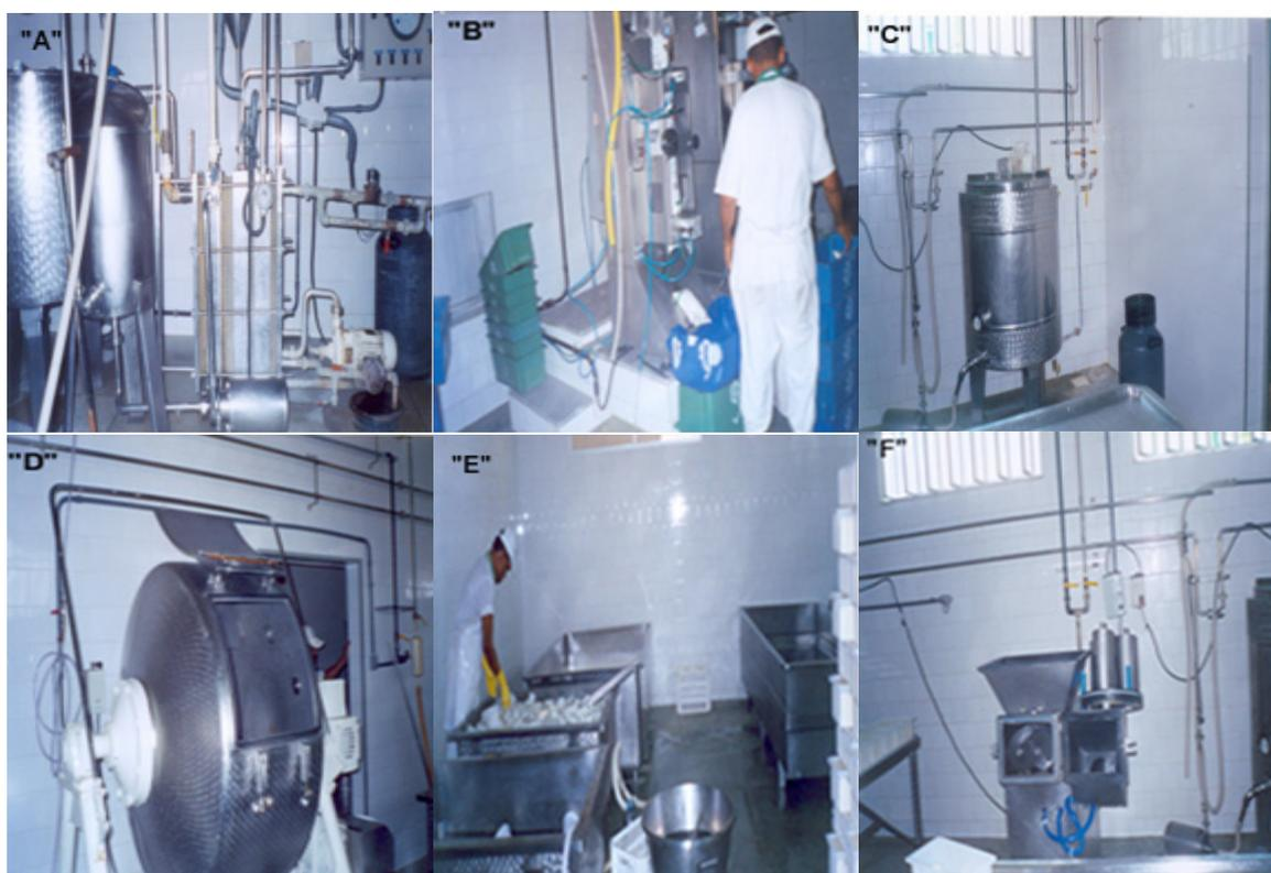
**Figura 4.8:** A. Pasteurização do leite. B. Empacotamento do leite. C. Iogurteira. D. Batedeira de manteiga. E. Tanque para salmoura. F. Moldadeira de queijo.
