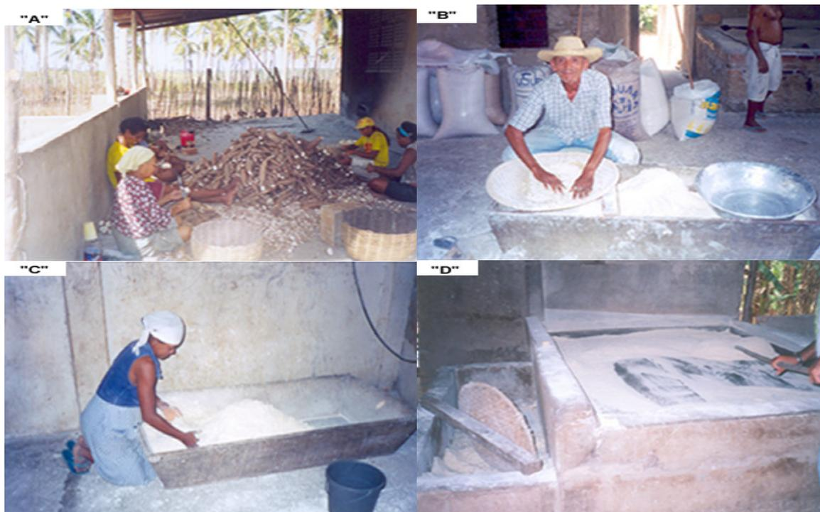
**Figura 4.10: A. Descascamento da mandioca. B. Peneiragem. C. Esfarelamento. D. Torração.**
