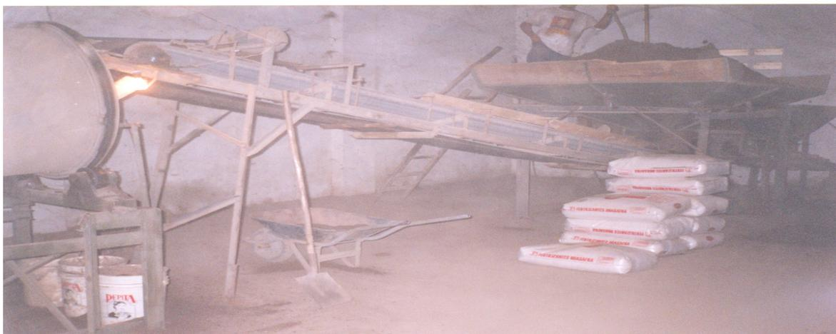
**Figura 4.7: Granulagem da rocha fosfática.**
