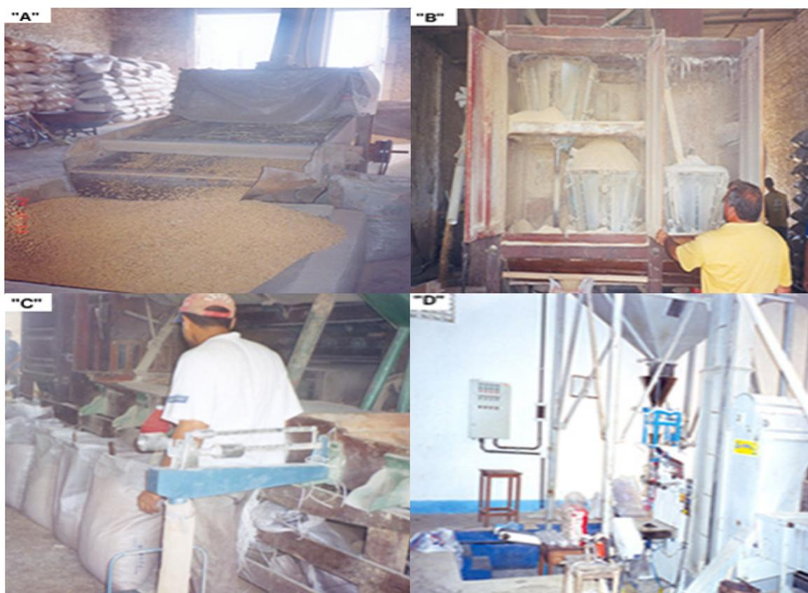
**Figura 4.6:** A. Limpeza do arroz. B. Branqueamento e polimento. C. Classificação do arroz. D. Ensacamento.
