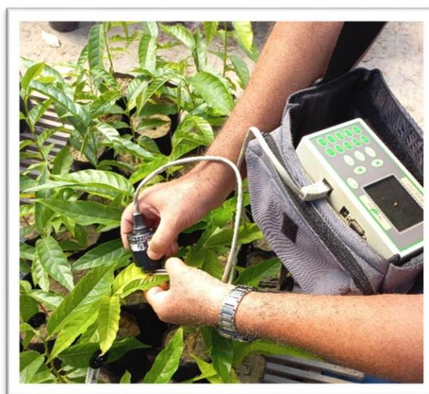
**Figura 7.** Fluorômetro portátil.
