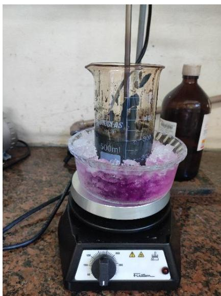
Figura 6: Aparato utilizado para controle da temperatura da síntese de Hummers.
