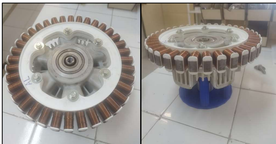
Figura 29. Estator construído em nosso laboratório.
