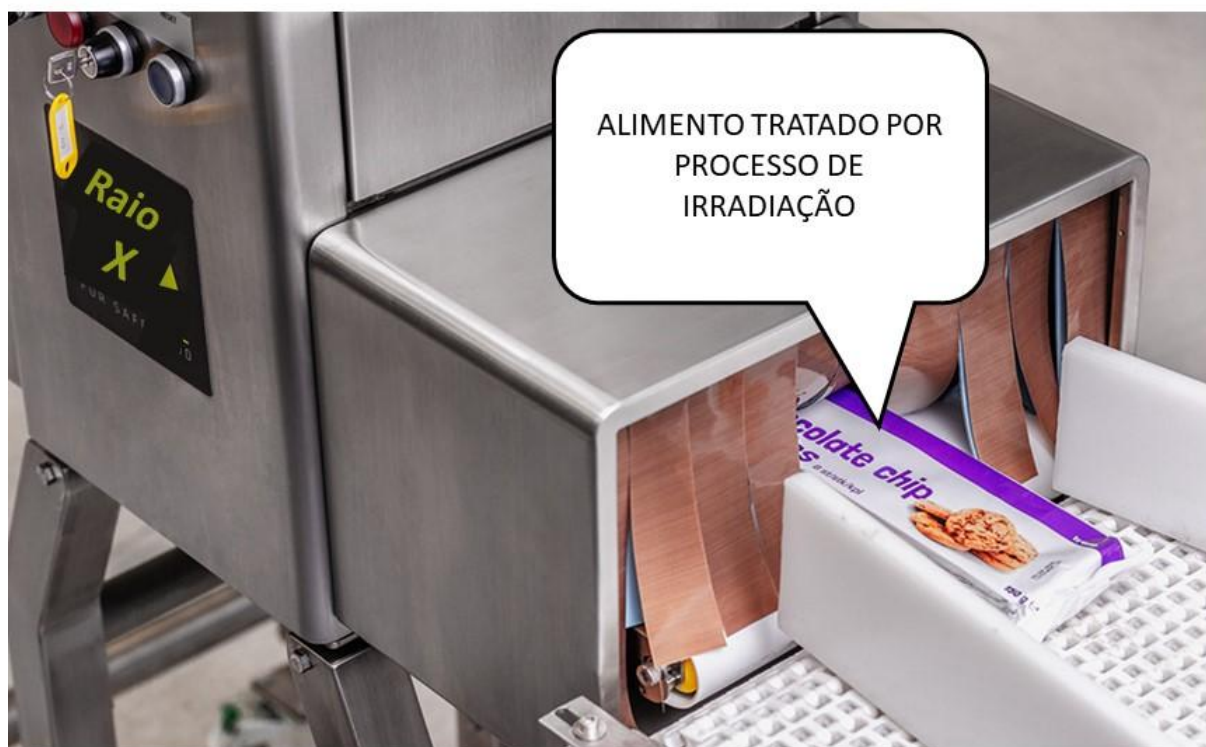
Figura 6. Equipamento de irradiação de alimentos por raios X.
