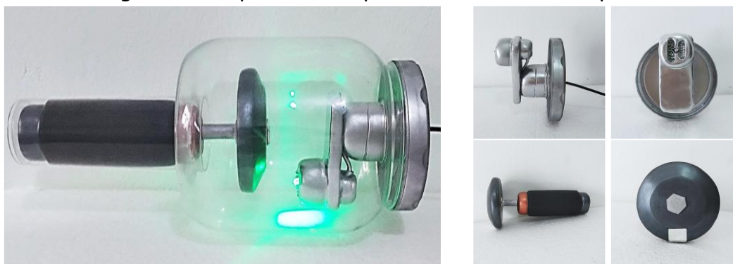
Figura 2. Maquete da ampola de raios X e suas partes.
