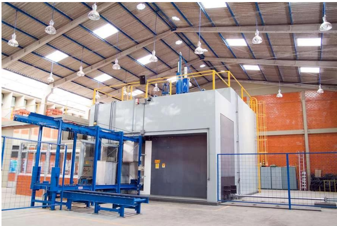
Figura 3. Irradiador de cobalto-60 multipropósito, localizado no IPEN.
