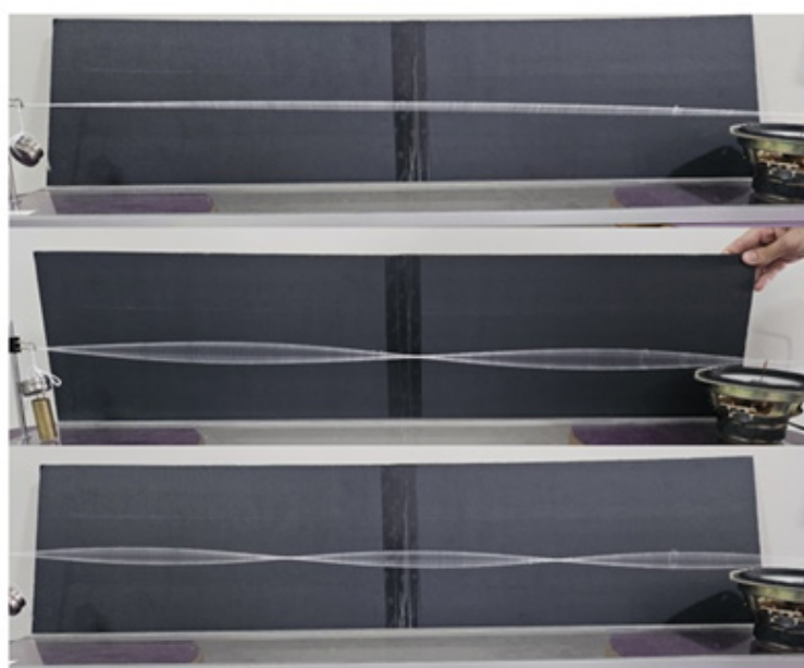
Figura 3.1: Primeiro, segundo e terceiro harmônico para a corda com extremos fixos.
