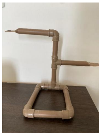
Figura 3: Suporte para fixação dos papéis hidrossensíveis.
