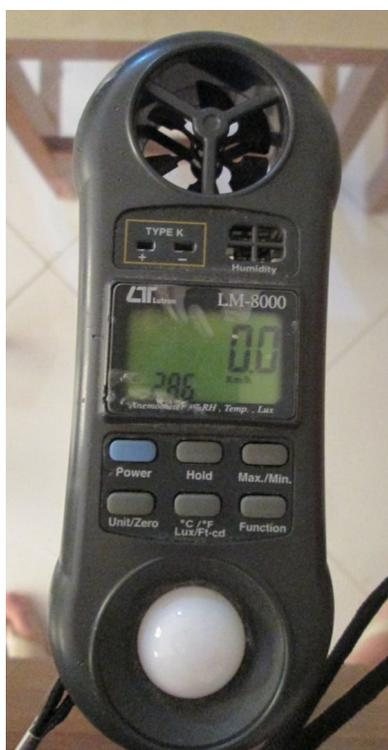
**Figura 20 - Anemômetro (*LUTRON Eletronic Enterprise Model: LM-8000*) utilizado para medir a velocidade do vento na frente do fogo durante as queimas laboratoriais (Fonte: O autor).**
