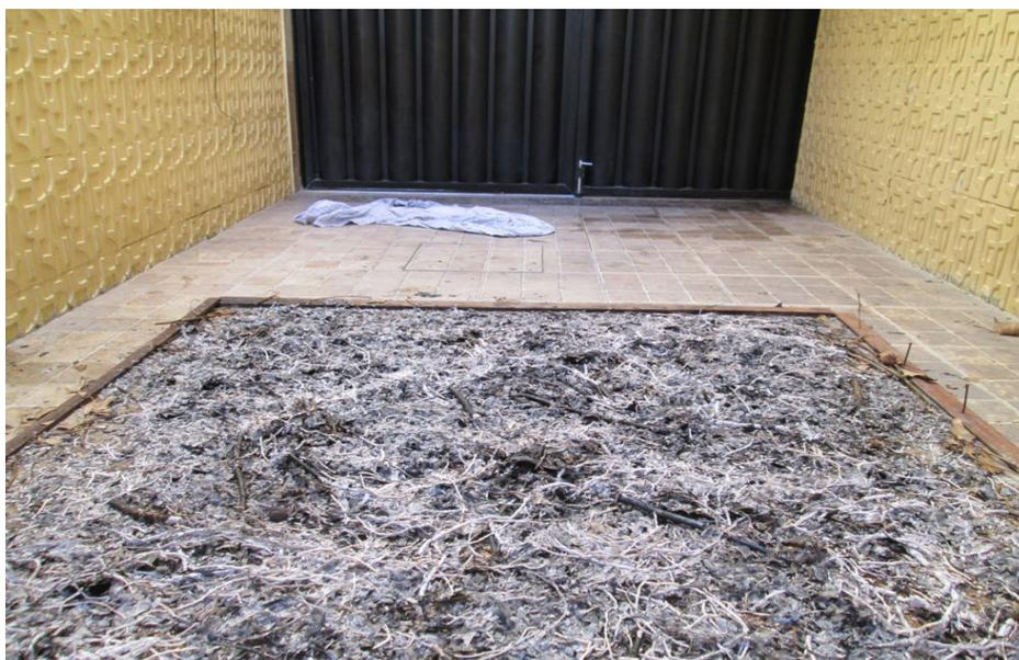
Figura 15 - Mesa de combustão do material combustível com destaque para o portão com o qual o vento era controlado. Quando fechado o fluxo de vento era mínimo, quando aberto velocidades maiores eram registradas (Fonte: O autor).
