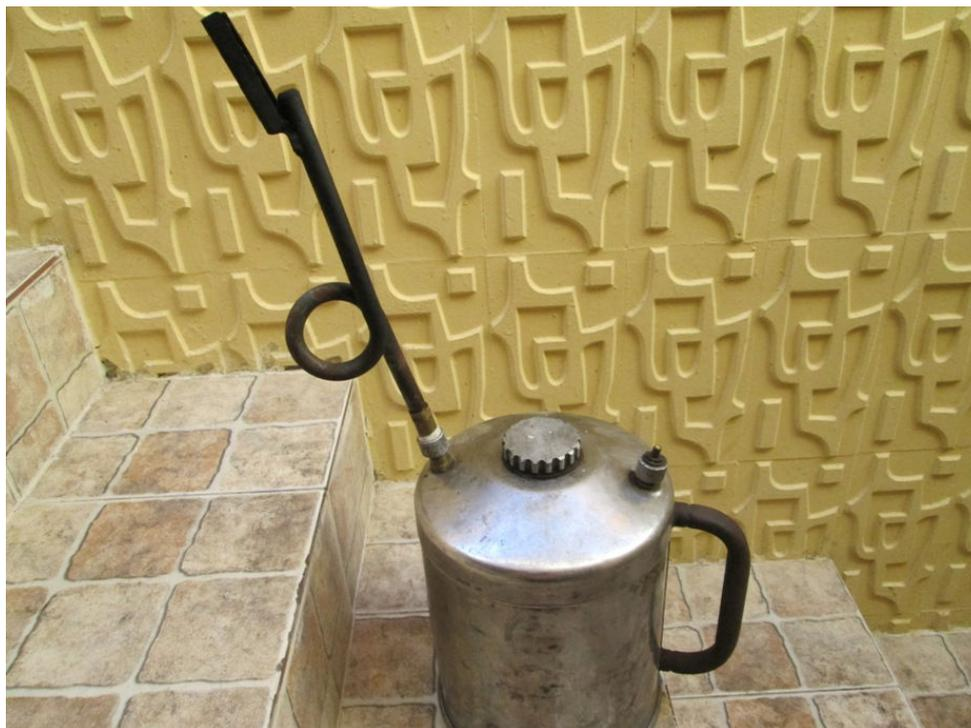
**Figura 17 - Pinga fogo utilizado para realizar a ignição do material combustível durante a realização das queimas laboratoriais (Fonte: O autor).**
