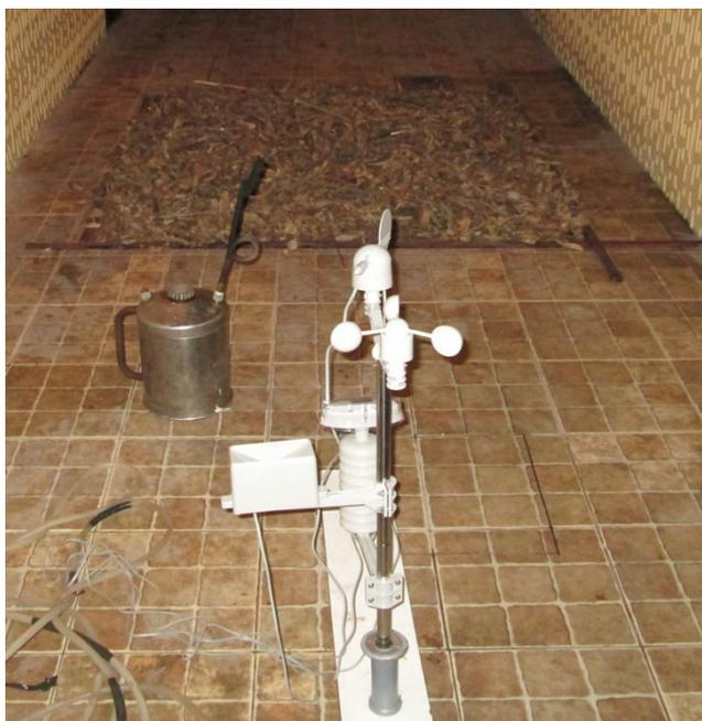
**Figura 19** - Estação meteorológica (*Professional Weatherwise Wireless Weather Station Model: SW-1090-SOLAR*) utilizada para definir os valores da temperatura e umidade relativa do ar pré-queima (Fonte: O autor).
