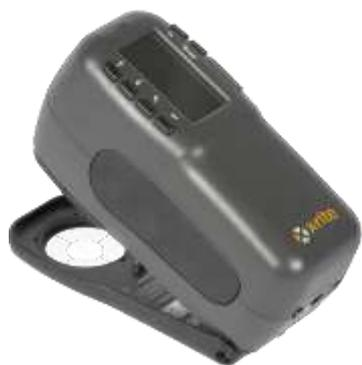
**Figura 2:** Espectrofotômetro X-Rite 962 empregado no estudo com fundo preto e branco para aferição das amostras. Arquivo de imagens do Google.
