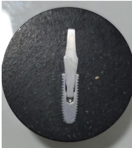
**Figura 3:** Amostra após embutimento e lixamento.
