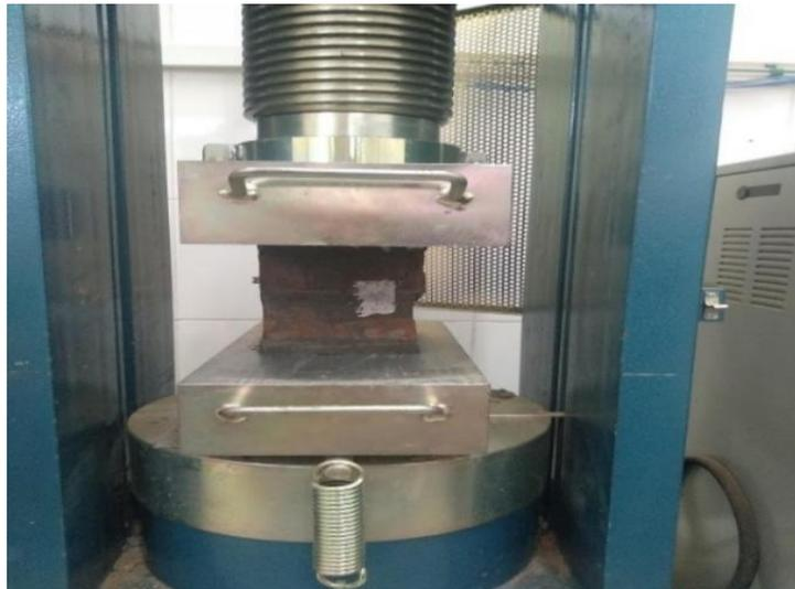
Figura 9. Etapas realizadas para ensaio de resistência à compressão. Corte dos tijolos ao meio; Capeamento das partes; Máquina utilizada para realizar o ensaio de resistência à compressão
