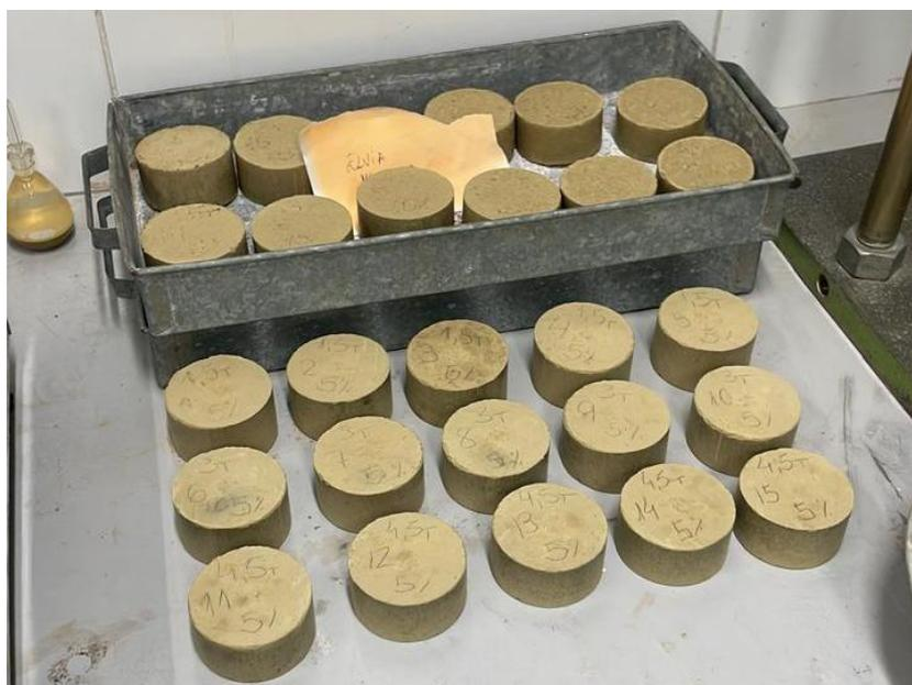
Figura 7. Corpos de prova cilíndricos (6,0 × 4,0 cm) moldados com diferentes proporções de solo, cimento e gesso reciclado. As amostras foram identificadas e organizadas para cura natural antes da realização dos ensaios físico-mecânicos.
