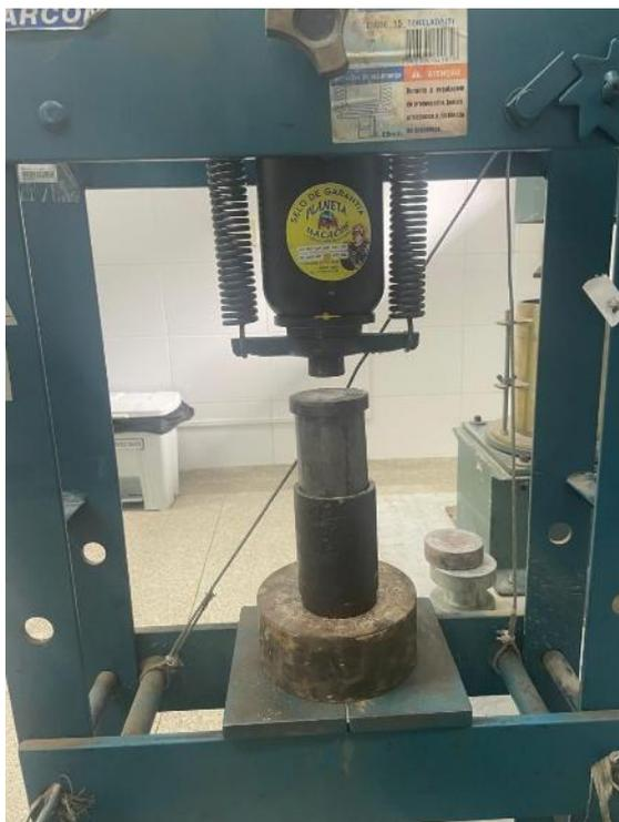
Figura 8. Prensa hidráulica manual utilizada na moldagem dos corpos de prova cilíndricos.
