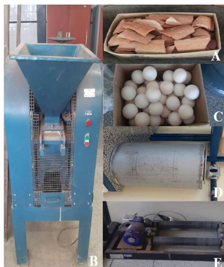
Figura 4 - Etapas da trituração das telhas cerâmicas: A) Telhas cerâmicas a serem trituradas; B) Triturador de materiais grossos, moinho de mandíbulas; C) Bolas de alumina que são colocadas no cilindro a ser anexado no encaixe do aparelho; D) Cilindro do moinho de bolas; E) Aparelho do encaixe do cilindro de moinho de bolas. Fonte: Autora (2025).
