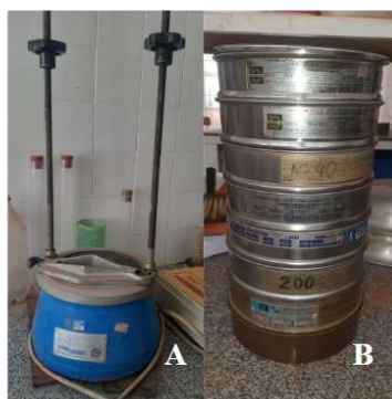
Figura 5 - Conjunto de peneirador: A) Peneirador Elétrico; B) Peneiras de aberturas de 1,18 mm, 590 \mu\text{m} , 425 \mu\text{m} , 250 \mu\text{m} , 150 \mu\text{m} , 75 \mu\text{m} e 53 \mu\text{m} e o fundo. Fonte: Autora (2025).
