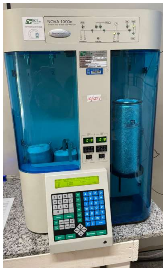
Figura 10- Equipamento NOVA 1000e, Surface Area & Pore Size Analyzer. Quantachrome. Fonte: Autora (2025).
