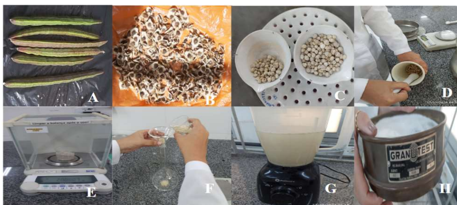
Figura 7- Etapas para obtenção do coagulante de moringa: A) Vagem da moringa. B) Semente com casca. C) Semente descascada. D) Trituração da semente. E) Pesagem do pó após passar pela peneira com abertura de 0,125 mm.
